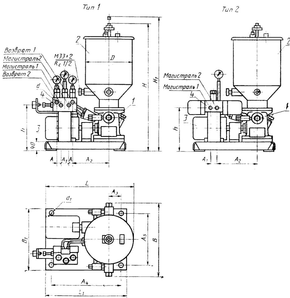
**1—насос; 2—резервуар; 3—электродвигатель; 4—двухмагистральный распределитель**
