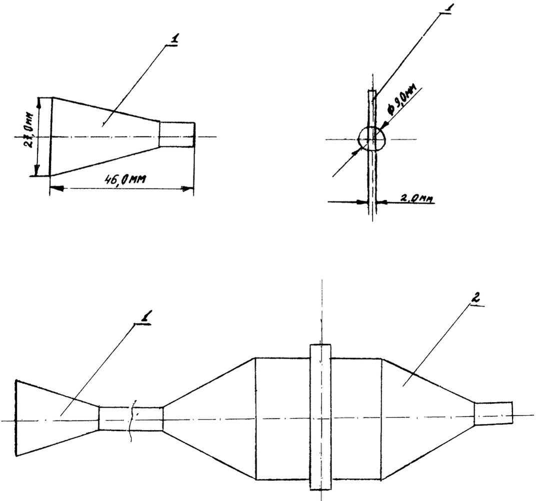
Рис. 3. Система отсоса веществ пылевидных:
