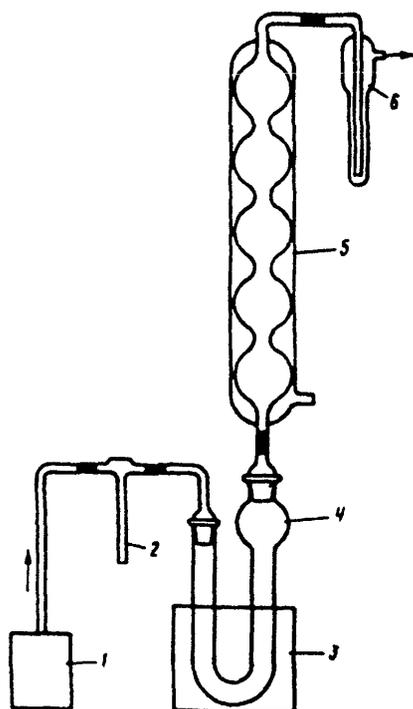
Рис. 1. Установка для извлечения ртути:
