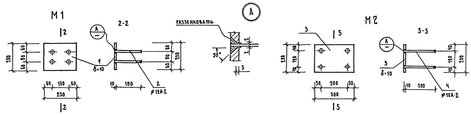
ОПАЛУБОЧНЫЙ ЧЕРТЕЖ ОПОРНОЙ ПОДУШКИ ОПБ-2-1
