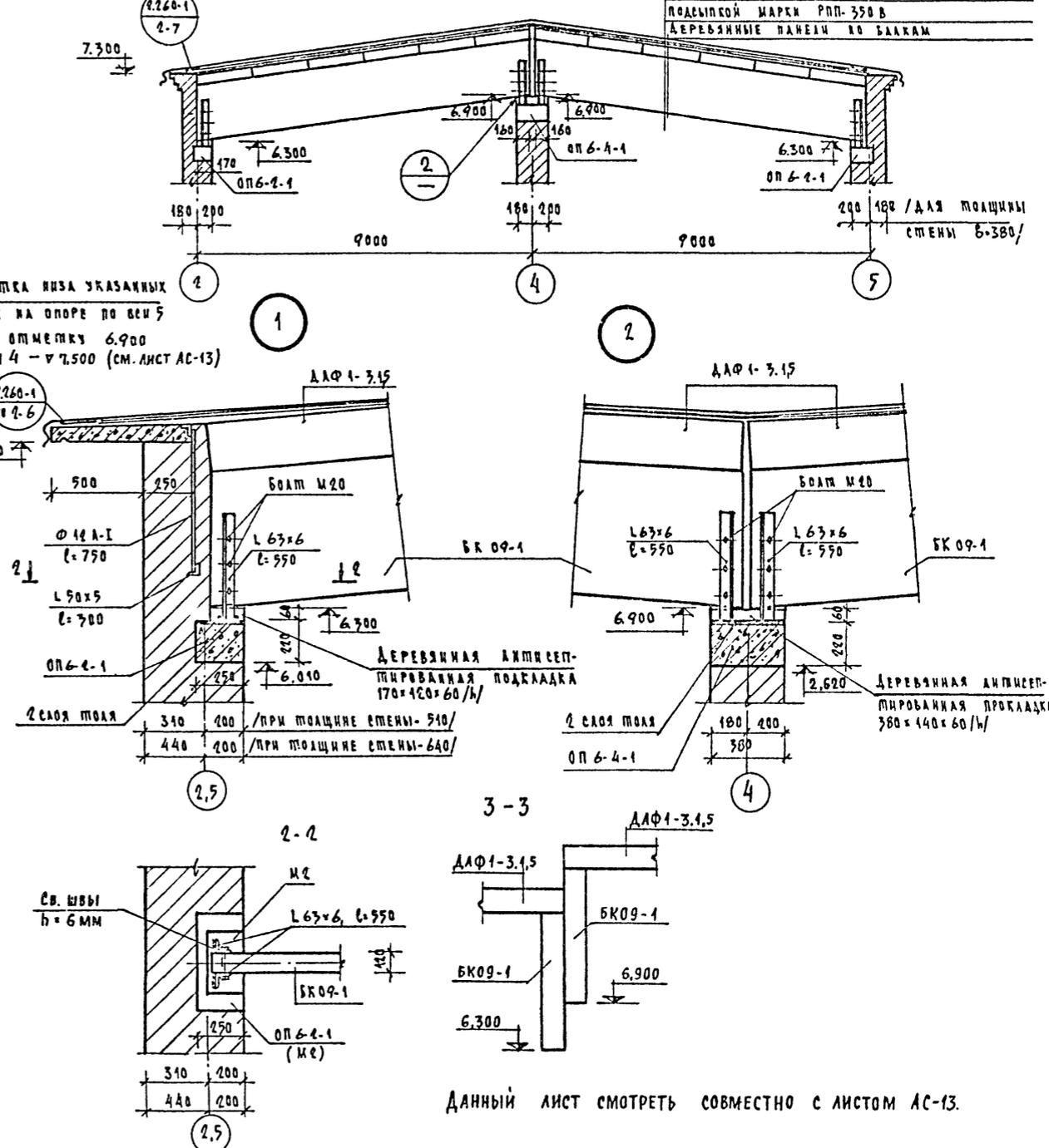
ПЛАН ПОКРЫТИЯ КИНОПРОЕКЦИОННОЙ НА ОШ. 6.050
