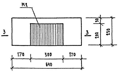
ОПАЛУБОЧНЫЙ ЧЕРТЕЖ ОПОРНОЙ ПОДУШКИ ОПБ-4-1
