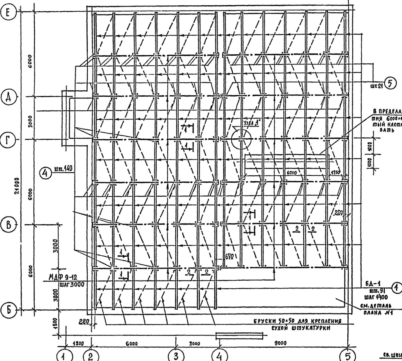
СХЕМА ПОДВЕСОК ДЛЯ КРЕПЛЕНИЯ ПОДВЕСНОГО ПОТОЛКА
