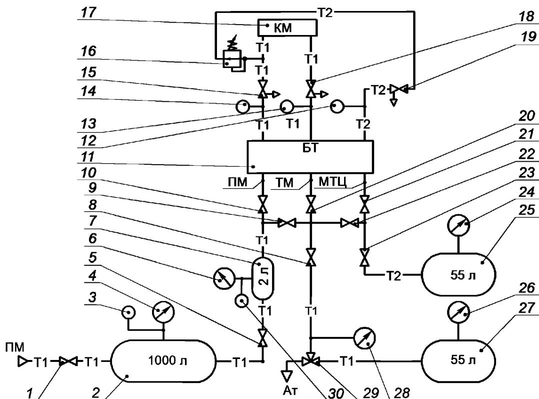
Ат — атмосфера, БТ — устройство (блокировка тормозов), КМ — кран машиниста, МТЦ — магистраль тормозного цилиндра, ПМ — питательная магистраль, ТМ — тормозная магистраль, Т1, Т2 — трубопроводы
