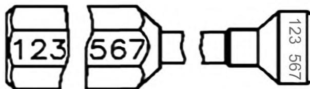
Рисунок Б.5 — Пример разрушения ЗПУ стержневого типа
