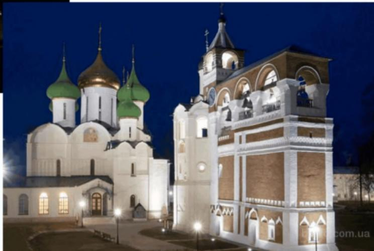
**Локальное (акцентное) освещение** - фрагментарное освещение всей или части поверхности фасада или его тектонических и декоративно-пластических элементов осветительными приборами с близких и средних расстояний, размещаемыми открыто или скрыто на освещаемом или соседних объектах, на опорах, подвесах, на земле, в земле и в воде.
