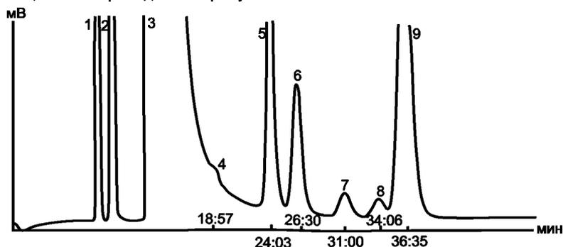
1 – этан; 2 – пропан; 3 – пропилен; 4 – изобутан; 5 – пропандиен; 6 – н-бутан; 7 – метилацетилена; 8 – цис-бутилен; 9 – бутадиен-1,3
