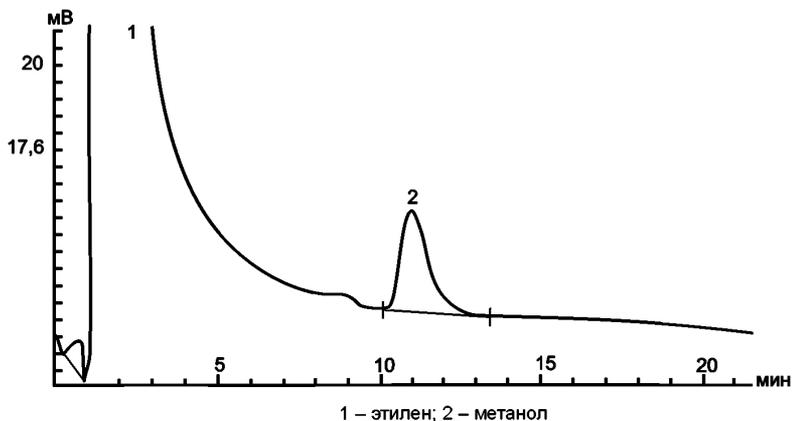
Рисунок 7 – Типовая хроматограмма градуировочной смеси метанола в этилене (при непосредственном определении метанола в этилене)
