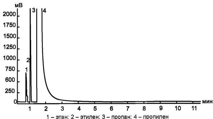
Рисунок 8 – Типовая хроматограмма пропилена на капиллярной колонке с  $Al_2O_3/Na_2SO_4$
