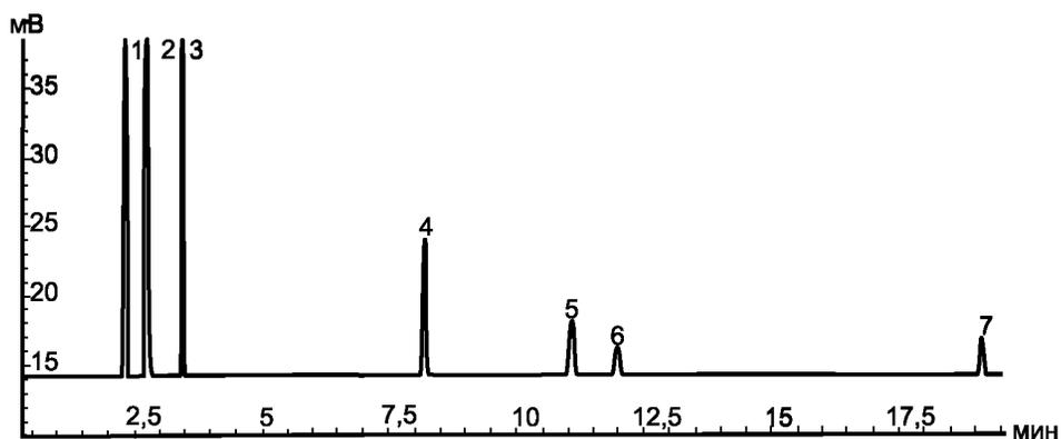
1 – метан; 2 – этан; 3 – этилен; 4 – пропилен; 5 – пропадиен; 6 – ацетилен; 7 – бутадиеи-1,3
