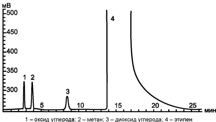
1 – оксид углерода; 2 – метан; 3 – диоксид углерода; 4 – этилен
