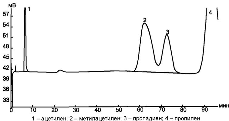
Рисунок 10 – Типовая хроматограмма градуировочной смеси ацетилена, метилацетилена, пропандиена в пропилене на колонке с углем СКТ
