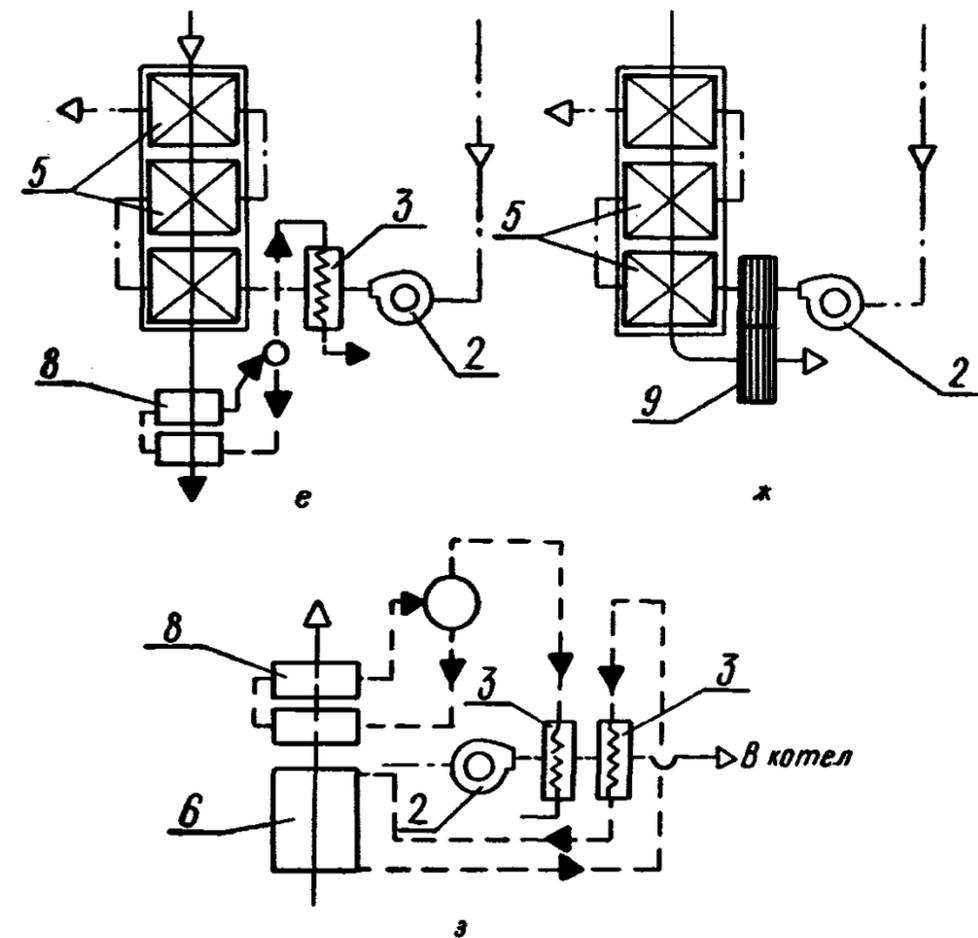
е — рециркуляция горячего воздуха на всас дутьевого вентилятора; ж — рециркуляция горячего воздуха по схеме МЭИ; з — рециркуляция холодного воздуха по схеме ТКЗ; 3 — экономайзер низкого давления с водяными калориферами регенеративный воздухоподогреватель; 5 — трубчатый воздухоподогреватель; 8 — газовые испарители; 9 — водонаполненные трубки; — — — газы; - - - - - вода
