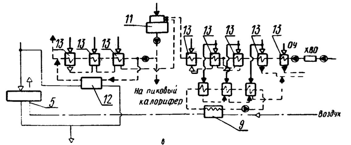
*b* — схема подогрева воздуха прямым конденсатом турбины воздухоподогревателю по газам; *в* — то же, с экономайзером высокого давления;
