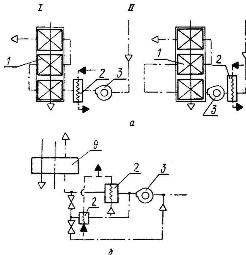
*a* — одноступенчатый подогрев воздуха в калориферах (паровых, во двухступенчатый подогрев воздуха в калорифере; *б* — многоступенчатый подогрев воздуха в калорифере питательной водой после ПВД с установкой 1. Трубчатый воздухоподогреватель; 2 — калориферы; 3 — вентилятор; подогреватели низкого давления; 7 — газовый подогреватель питательной воды; 10 — подогреватели
