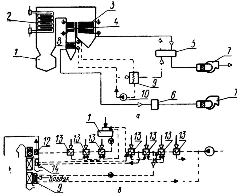
*a* — схема разделенных хвостовых поверхностей нагрева с газовым испарителем в сочетании с экономайзером низкого давления, включенным параллельно
