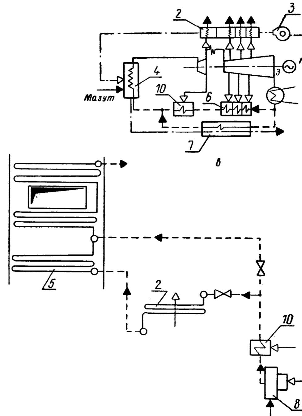
данных); I — на напоре вентилятора; II — на всасе вентилятора; *б* — чатый подогрев воздуха по схеме Витри-Сюр-Сен; 2 — подогрев в ка-дополнительного экономайзера высокого давления 4 — котел; 5 — экономайзер высокого давления; 6 — регенеративные ной воды; 8 — деаэратор; 9 — регенеративный воздухоподогреватель; высокого давления
