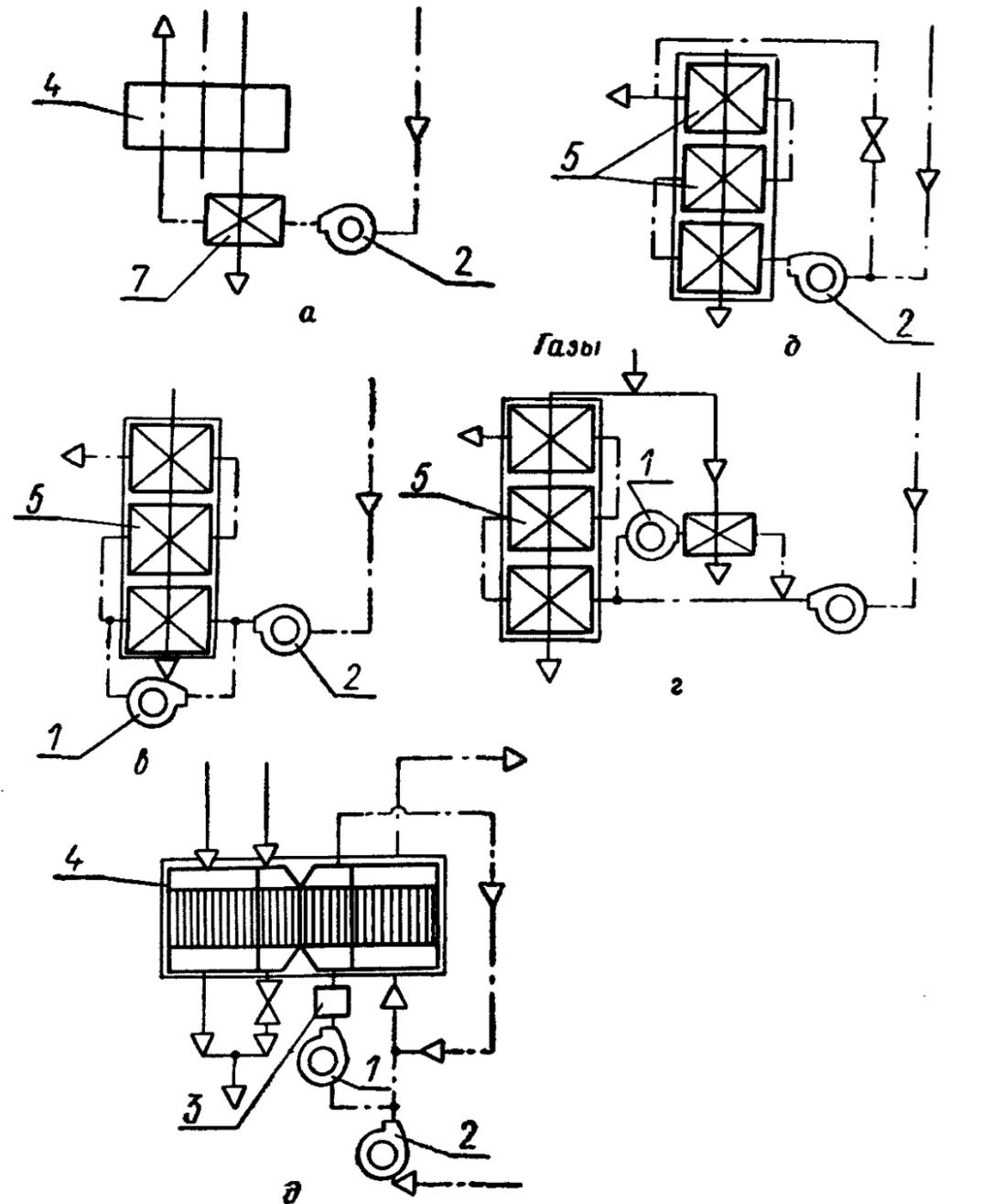
а — предварительный подогрев в стеклянном кубе; б — рециркуляция горячего воздуха на напор дутьевого вентилятора (схема ЗиО); в — рециркуляция горячей ТКЗ; г — газовый испаритель с паровым калорифером; ж — водонаполненная трубка; з — экономайзер низкого давления с водяными калориферами; 1 — вентилятор рециркуляции; 2 — основной вентилятор; 3 — калорифер; 4 — б — экономайзер низкого давления; 7 — стеклянный куб; — — — газы; - - - - - вода
