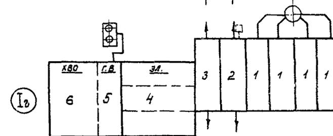
Варианты сочетаний блок-секций при выполнении компоновки котельной с однотипными котлами на 4<sup>х</sup> листак
