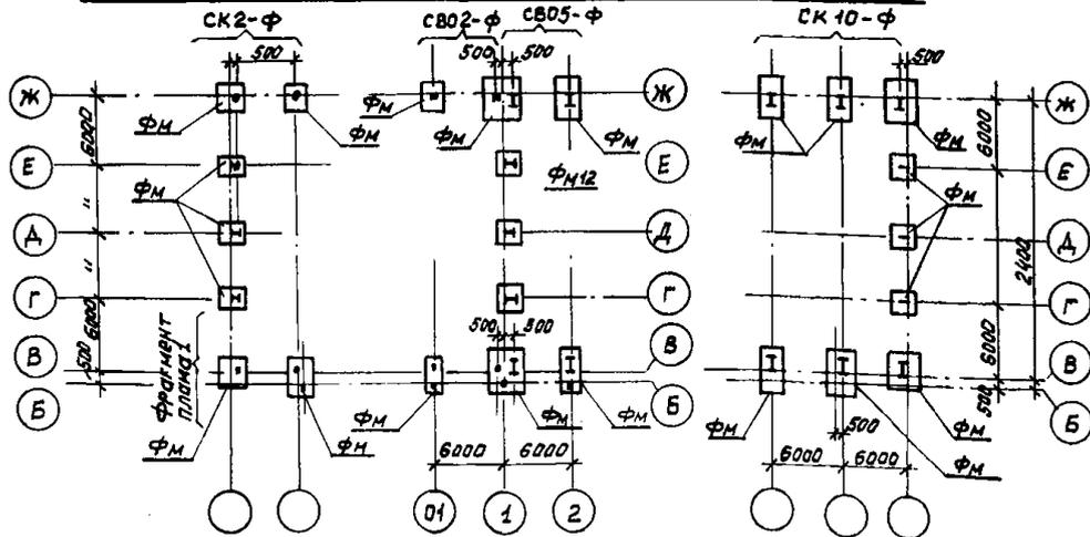
На данном листе приведены примеры маркировки секций здания, маркировочных схем, фундаментов секций и маркировки фрагментов стеновых панелей. Маркировочные схемы стеновых панелей торцов зданий приводятся полностью. Цифры в основной маркировке секций приняты условно.
