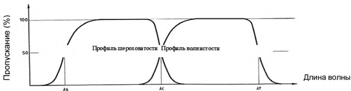
Рисунок 1 — Характеристики передачи профилей шероховатости и волнистости
