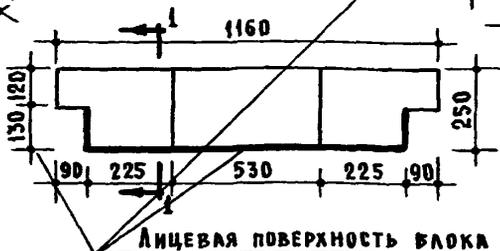
Щель для установки вентиляционного устройства применяется при спаренных оконных переплетах (серия II). При применении переплетов I серии щель не делать.
