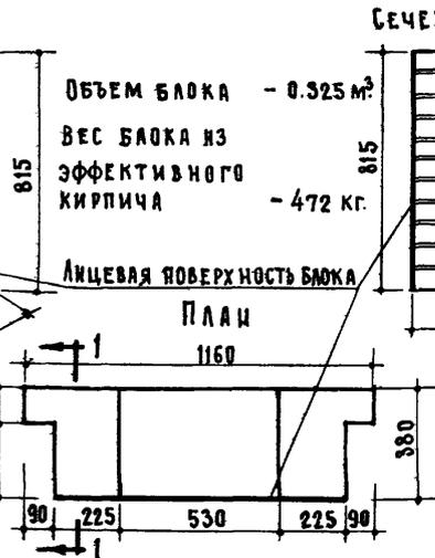
ЩЕЛЬ ДЛЯ УСТАНОВКИ ВЕНТИЛЯЦИОННОГО УСТРОЙСТВА ПРИМЕНЯЕТСЯ ПРИ СПАРЕННЫХ ОКОННЫХ ПЕРЕПЛАТАХ (СЕРИЯ II). ПРИ ПРИМЕНЕНИИ ПЕРЕПЛАТОВ СЕРИИ I ЩЕЛЬ НЕ ДЕЛАТЬ.
