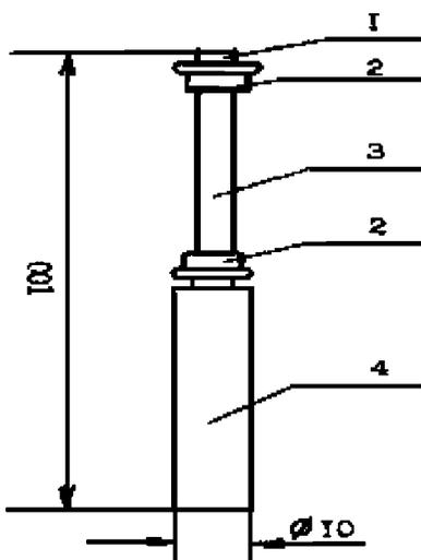
1 – пробка; 2 – обжимная втулка; 3 – тефлоновая трубка; 4 – баллончик с жидким ВХ
