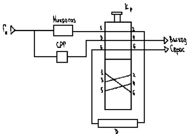
Гн – газ-носитель; СРГ – стабилизатор расхода газа; Кр – шестиходовой переключаящий кран;
