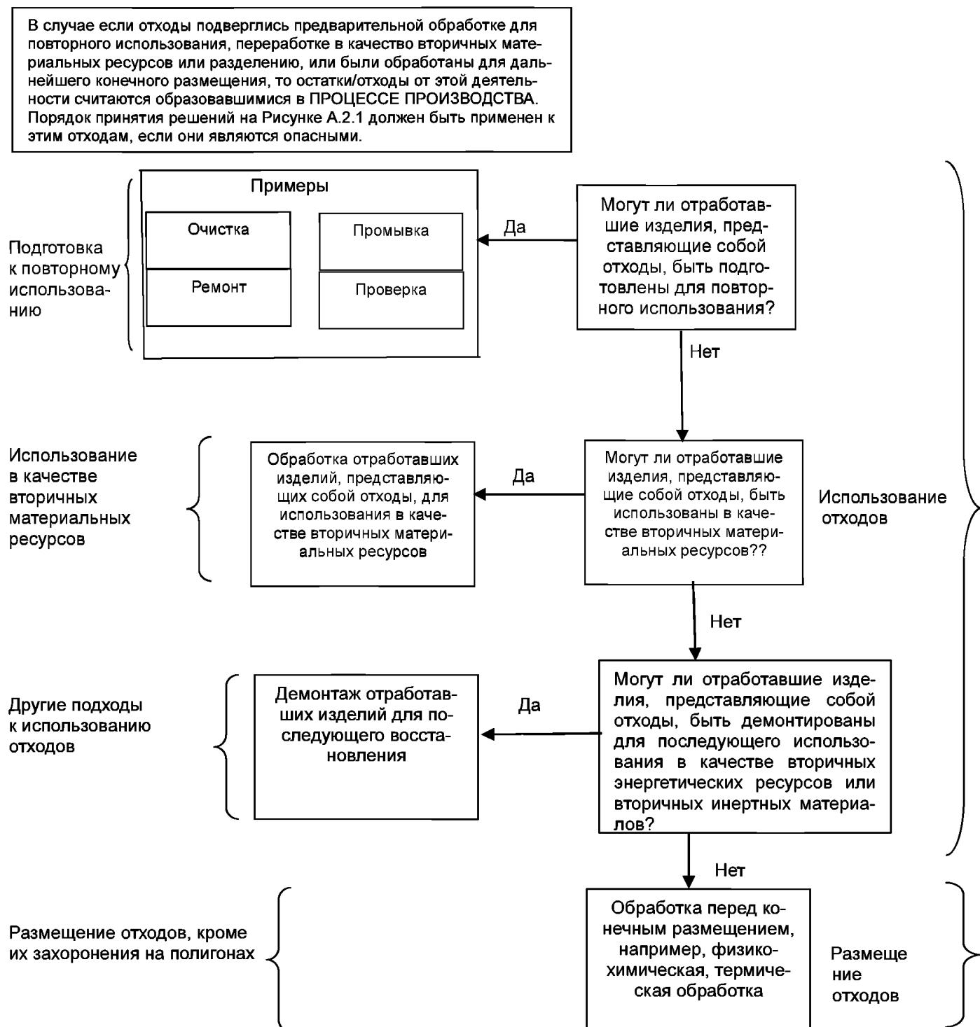
Рисунок Б.3.1 – Порядок принятия решений при обращении с отработавшими изделиями, отнесенным к отходам
