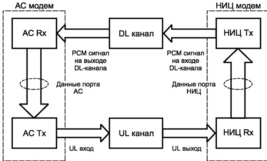
Рисунок В.1 — Общая схема функционирования тональных модемов
