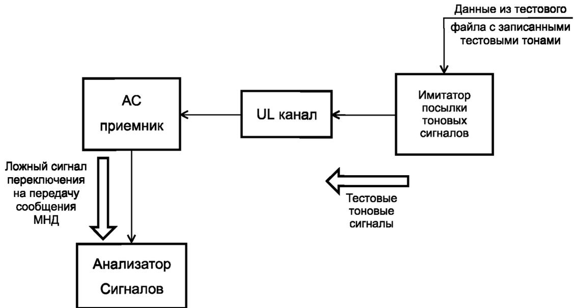
Рисунок В.5 — Общая схема проведения проверки ложного детектирования экстренного вызова при наличии сигнальных тонов на входе приемника тонального модема
