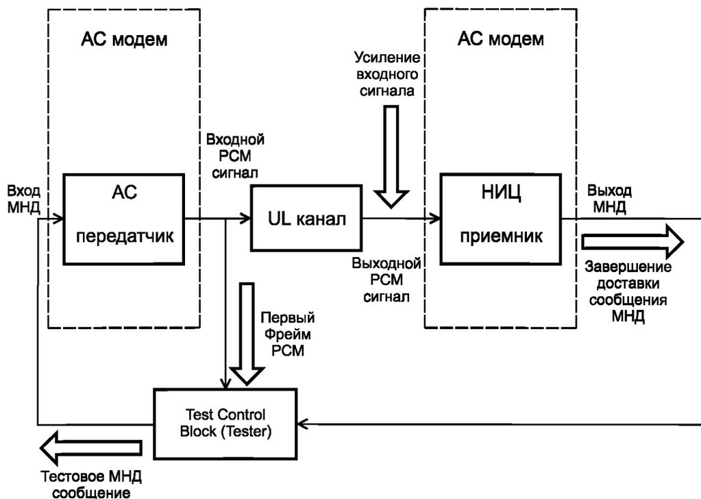
Рисунок В.4 — Общая схема проведения тестирования при измерении времени передачи сообщения МНД при различных значениях коэффициента усиления РСМ сигнала
