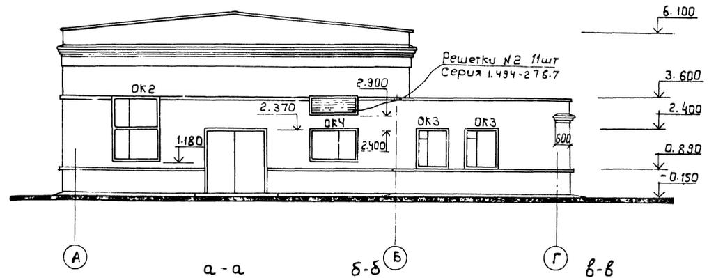
Схема расположения элементов заполнения оконных проемов
