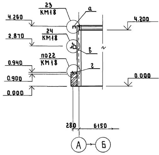
1. Монтаж элементов вести на болтах нормальной точности М16 и на электросварке.
