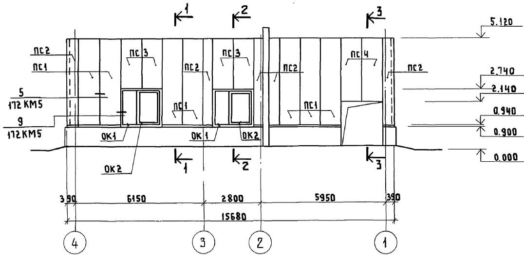
СХЕМА РАСПОЛОЖЕНИЯ СТЕНОВЫХ ПАНЕЛЕЙ ПО ОСИ „Ч“.
