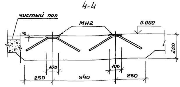
Спецификация к схеме расположения фундаментов и схема расположения закладных изделий.
