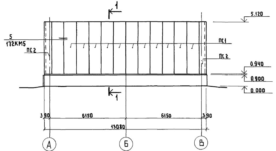
СХЕМА РАСПОЛОЖЕНИЯ СТЕНОВЫХ ПАНЕЛЕЙ ПО ОСИ „1“.
