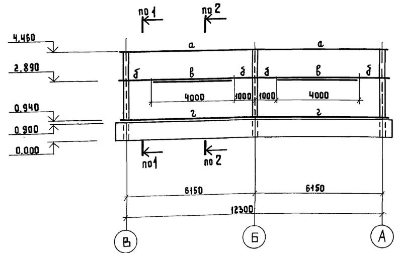
СХЕМА РАСПОЛОЖЕНИЯ ЭЛЕМЕНТОВ ФАХВЕРКА
