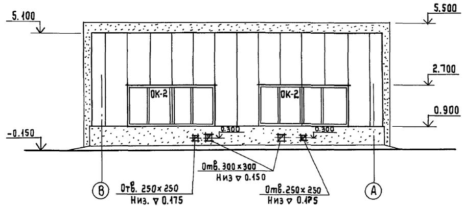
СХЕМА ЗАПОЛНЕНИЯ ОКОННЫХ ПРОЕМОВ.
