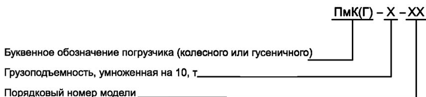
4.2.1 Пример индексации малогабаритного колесного погрузчика грузоподъемностью 0,6 т третьей модели:
