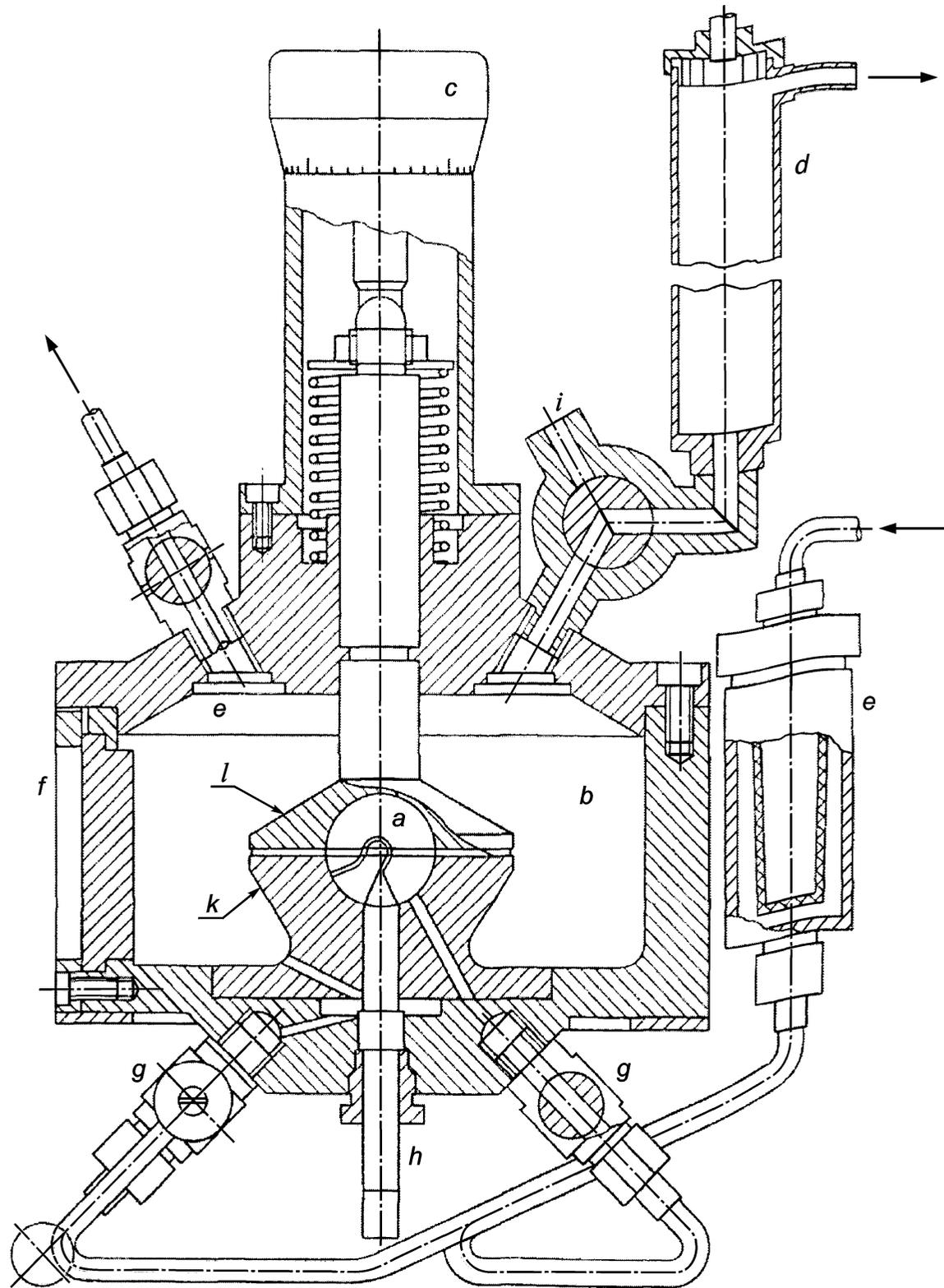
*a* — внутренняя камера; *b* — внешняя цилиндрическая оболочка; *c* — микрометрический винт; *d* — выходное отверстие; *e* — огнепреградители; *f* — смотровые окна; *g* — входные вентили; *h* — искровой электрод; *i* — выходное отверстие; *k* — нижняя регулируемая поверхность зазора; *l* — верхняя регулируемая поверхность зазора
