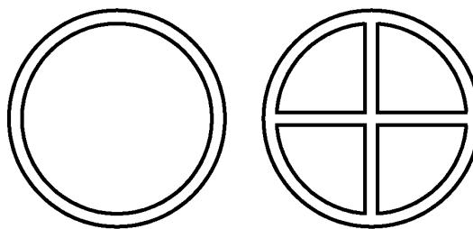
Рисунок 2 — Окнныне блоки с ячейками круглой формы
