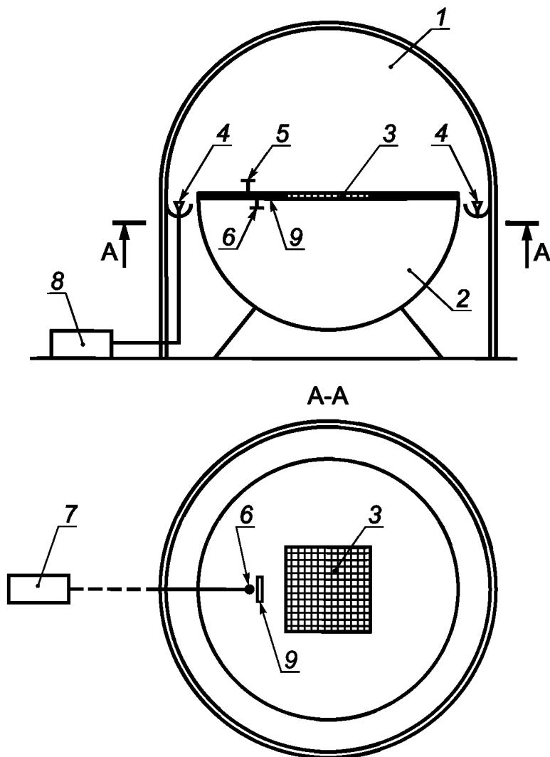
1 — источник диффузного света; 2 — светомерная камера; 3 — проем с опорной решеткой; 4 — осветительные приборы источника света; 5 — измерительный преобразователь излучения люксметра наружной камеры; 6 — измерительные преобразователи люксметров внутренней камеры; 7 — регистрирующие устройства люксметров; 8 — регулятор напряжения осветительных приборов; 9 — экран фотоэлемента от прямого света источника
