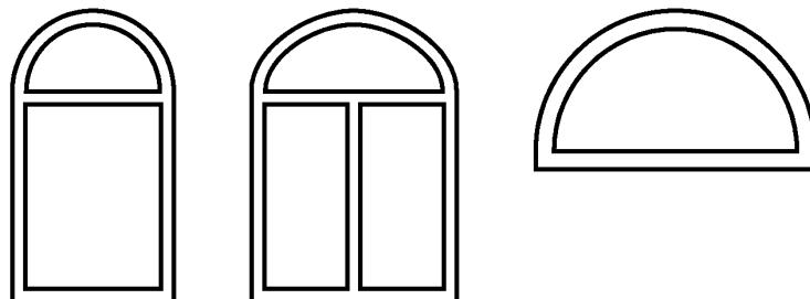
Рисунок 3 — Окнныне блоки полуокруглой и сложной формы
