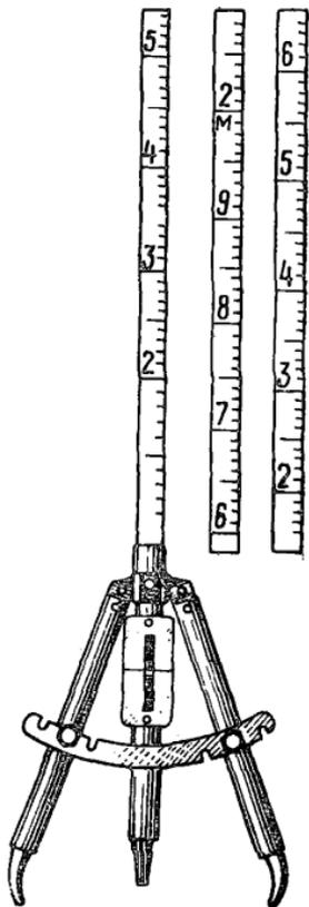
Рис. 35. Диаметромер конструкции С. П. Кузнецова
