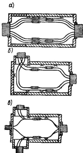
Рис. 30. Сборные железобетонные колодцы для телефонных кабелей
