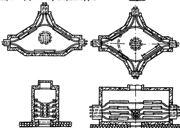
Рис. 33. Колодцы для кабельных блоков
