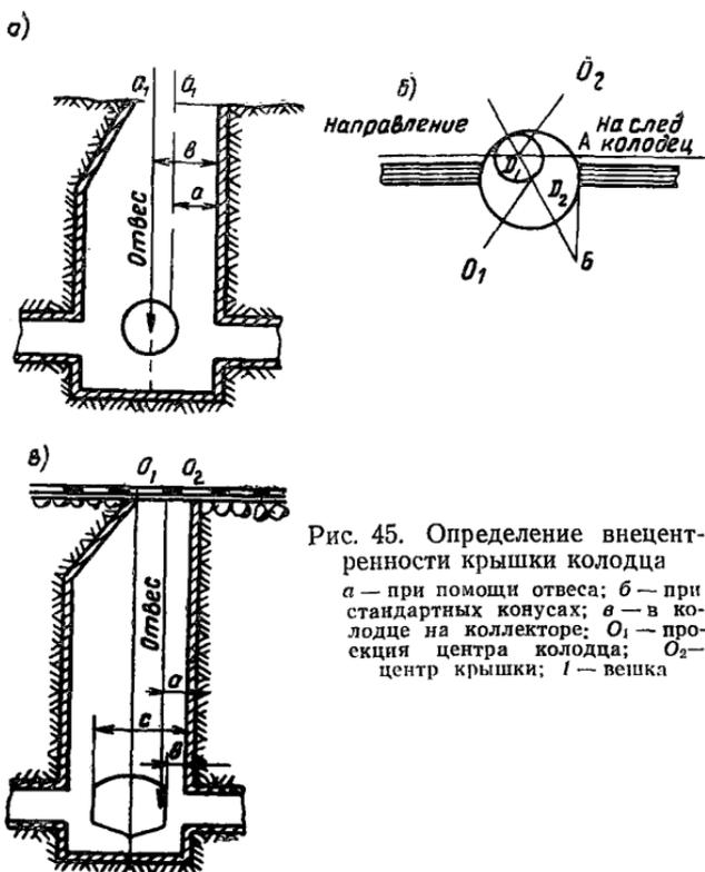
Рис. 45. Определение внецентренности крышки колодца
