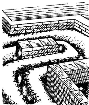
Рис. 19. П-образный компенсатор
