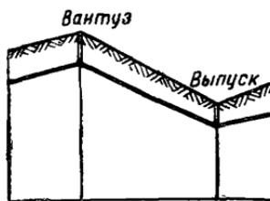
Рис. 3. Расположение вантузов и выпусков
