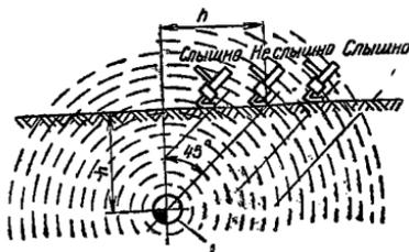
Рис. 43. Поисковый контур с уголком при определении глубины заложения трассы
