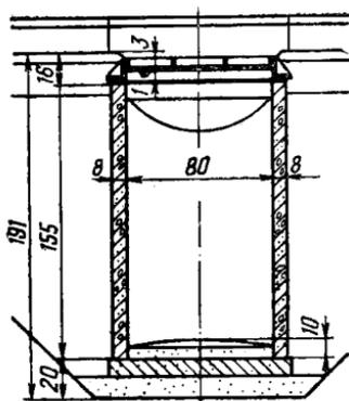
Рис. 21. Дождеприемный колодец
