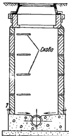
Рис. 8. Сборный железобетонный колодец
