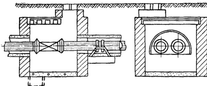
Рис. 20. Камера на теплосети
