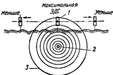
Рис. 42. Поиск по максимуму сигнала
