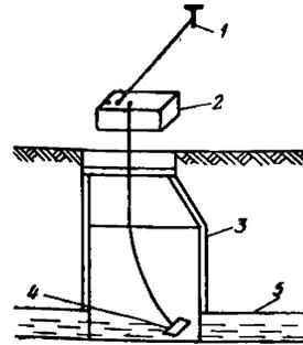
Рис. 39. Схема подключения генератора к неметаллической прокладке с использованием металлической пластинки
