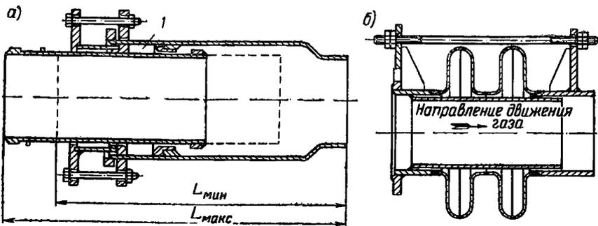
Рис. 13. Компенсаторы
