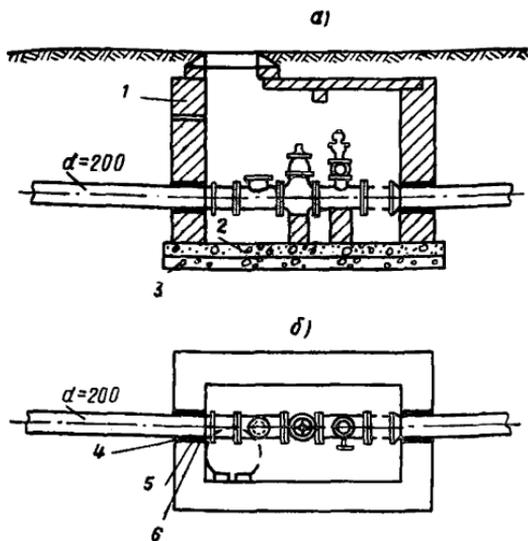
Рис. 1. Колодец с вантузом и задвижкой на напорном трубопроводе
