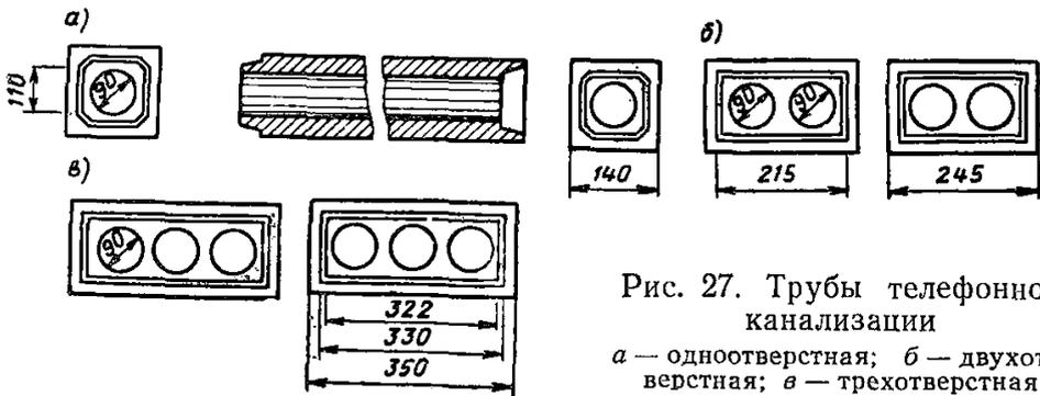
Рис. 27. Трубы телефонной канализации
