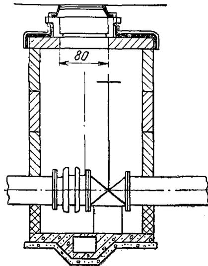
Рис. 17. Компенсатор с задвижкой, установленный в колодце
