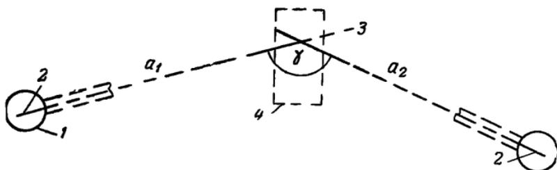
Рис. 34. Определение направлений на засыпанный колодец при помощи деревянных планок
