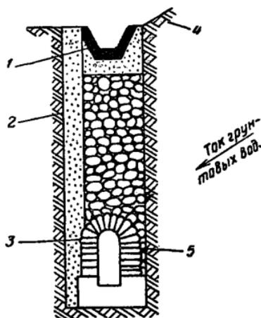
Рис. 24. Галерея для стока грунтовых вод
