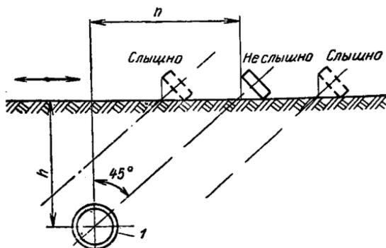
Рис. 44. Поисковый контур ТКИ с рамкой, закрепленной под углом  $45^\circ$ , при определении глубины заложения трассы
