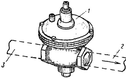
Рис. 14. Регулятор давления
