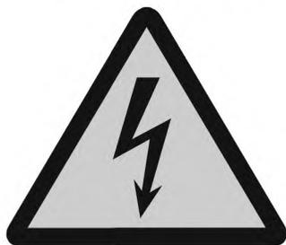
Знак на рисунке 1 следует устанавливать возле источников напряжения класса Б, например комплектов топливных элементов, батарей, суперконденсаторов. Такой же знак должен быть установлен на барьерах/кожухах, которые при их снятии открывают доступ к токоведущим частям цепи на напряжение класса Б и/или основной изоляции.
