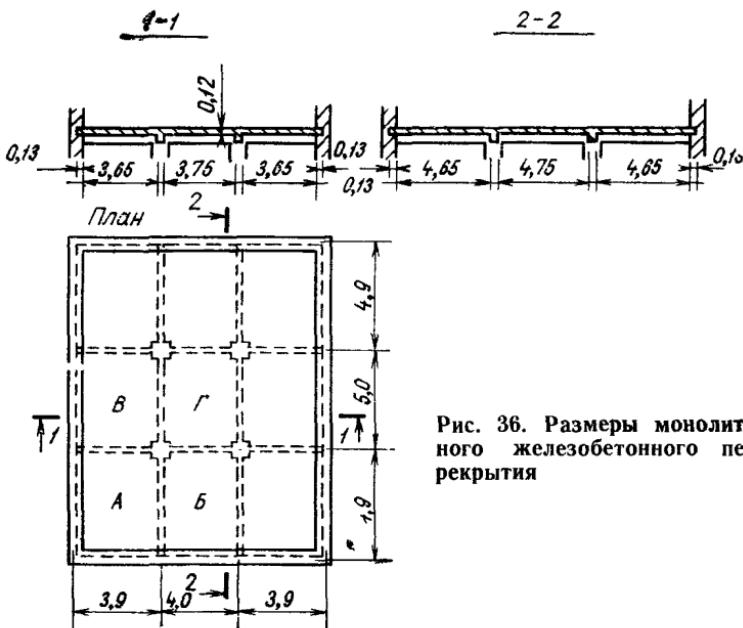
Рис. 36. Размеры монолитного железобетонного перекрытия
