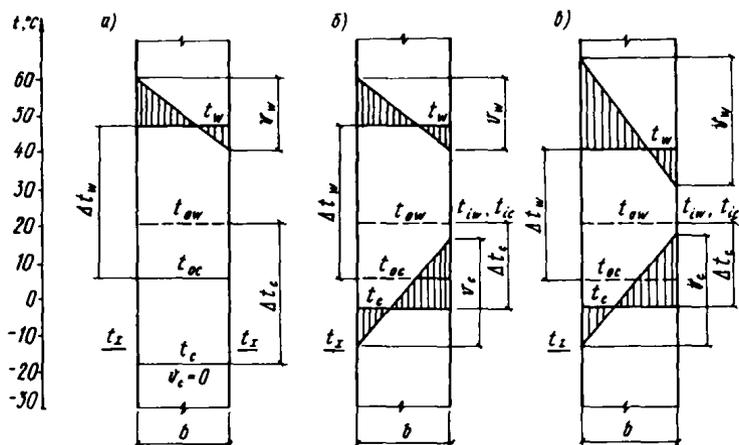
Изменение во времени средней температуры  $\Delta t_w$ ,  $\Delta t_c$  и перепада температур  $v_w$ ,  $v_c$  соответственно в теплое и холодное время года по сечению вертикальной стены из легкого бетона толщиной  $b = 25$  см в
