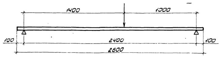
Нагрузка должна быть распределена равномерно по всей ширине плит.
