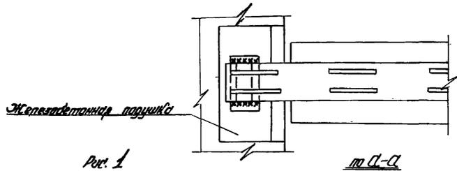
Привязка продольных стен во всех случаях принята нулевая /см.рис. 2,3 и 4/. В случае необходимости несущие стены могут иметь плиты со стороны внутренней поверхности стены /см.рис. 4/.
