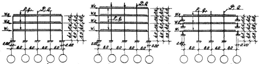
Схемы для под нормативную полезную нагрузку на межпанельные переделы ширины 1500 и 2000 мм<sup>2</sup>
