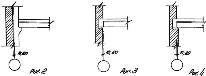
На рис. 2-4 плиты перекрытий условно не показаны. Расстояние от разбивочной оси до внутренней поверхности стены равно 10 мм принимается для стен из бетонных блоков или панелей, и равно 20 мм - для стен из кирпичных блоков или кирпичной кладки.
