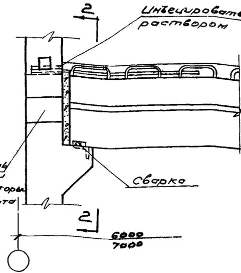
Закл. детали для приварки уголка, на котором опирается плита
