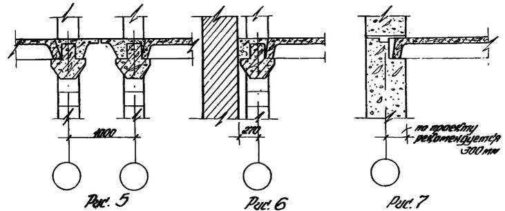
Фундаменты колонн или колонн подвальных этажей должны иметь наверху металлические оголовки по типу оголовков, проектируемых в колоннах.
