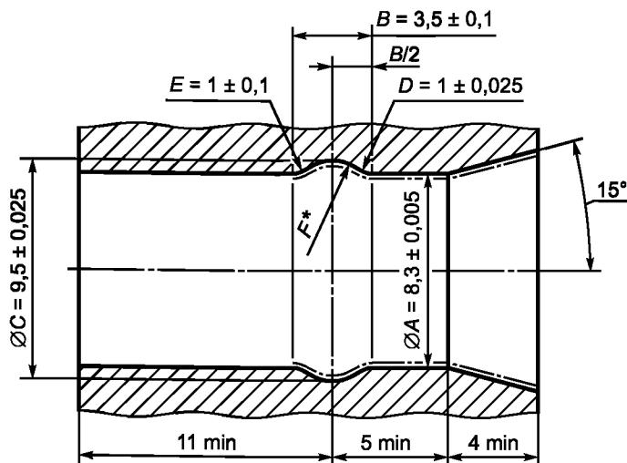
\* Значение F определяют построением, исходя из значений размеров A, B, C, D и E
