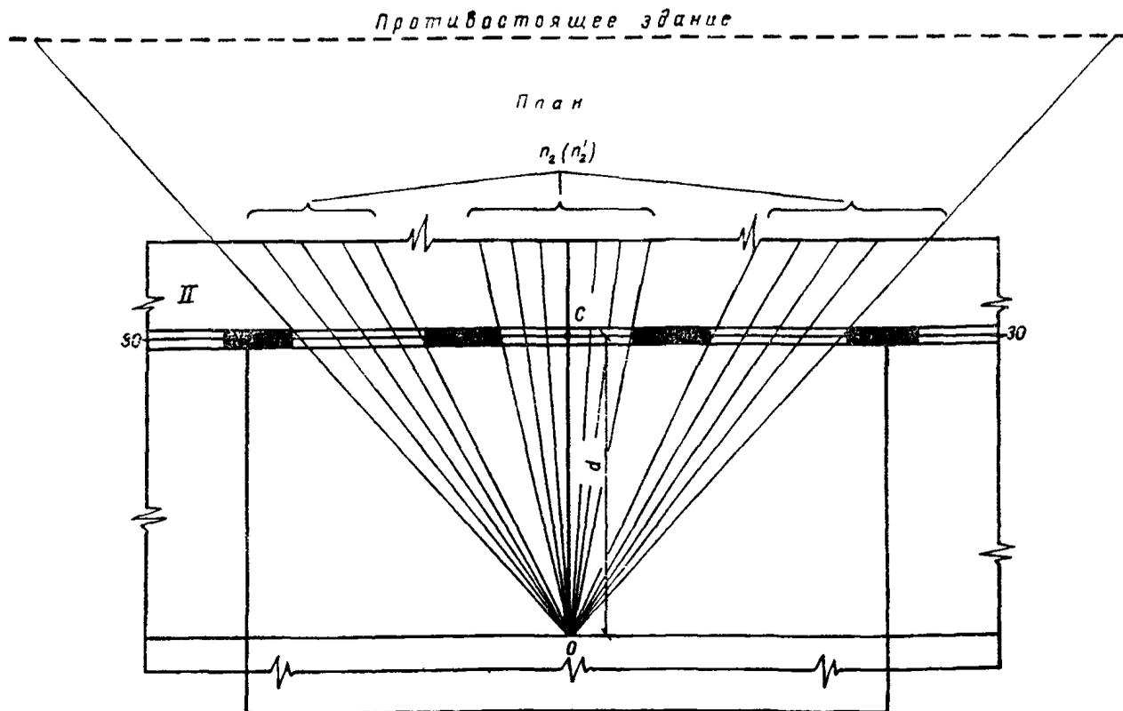
Рис. 9. Пример подсчета количества лучей  $n_2$  и  $n_2'$  (с использованием рис. 6), проходящих через световой проем (при боковом освещении) или на продольном разрезе помещения (при верхнем освещении)
