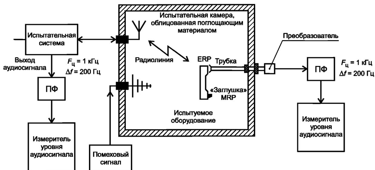
ПФ — полосовой фильтр;  $F_{ц}$  — центральная частота полосы пропускания фильтра;  $\Delta f$  — полоса пропускания фильтра;
