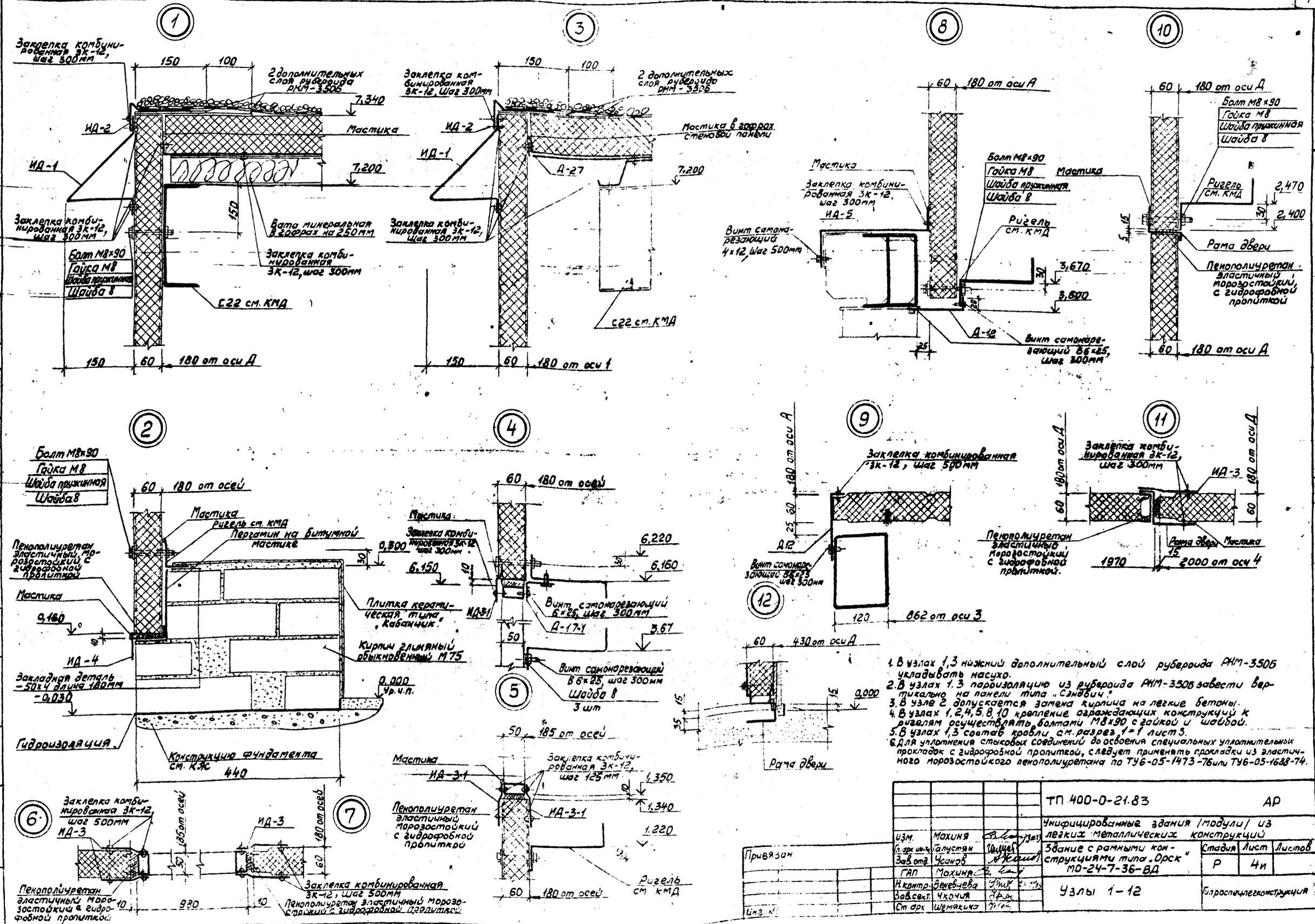
1. В узлах 1,3 нижний дополнительный слой рубероида РММ-350Б укладывать насухо.
