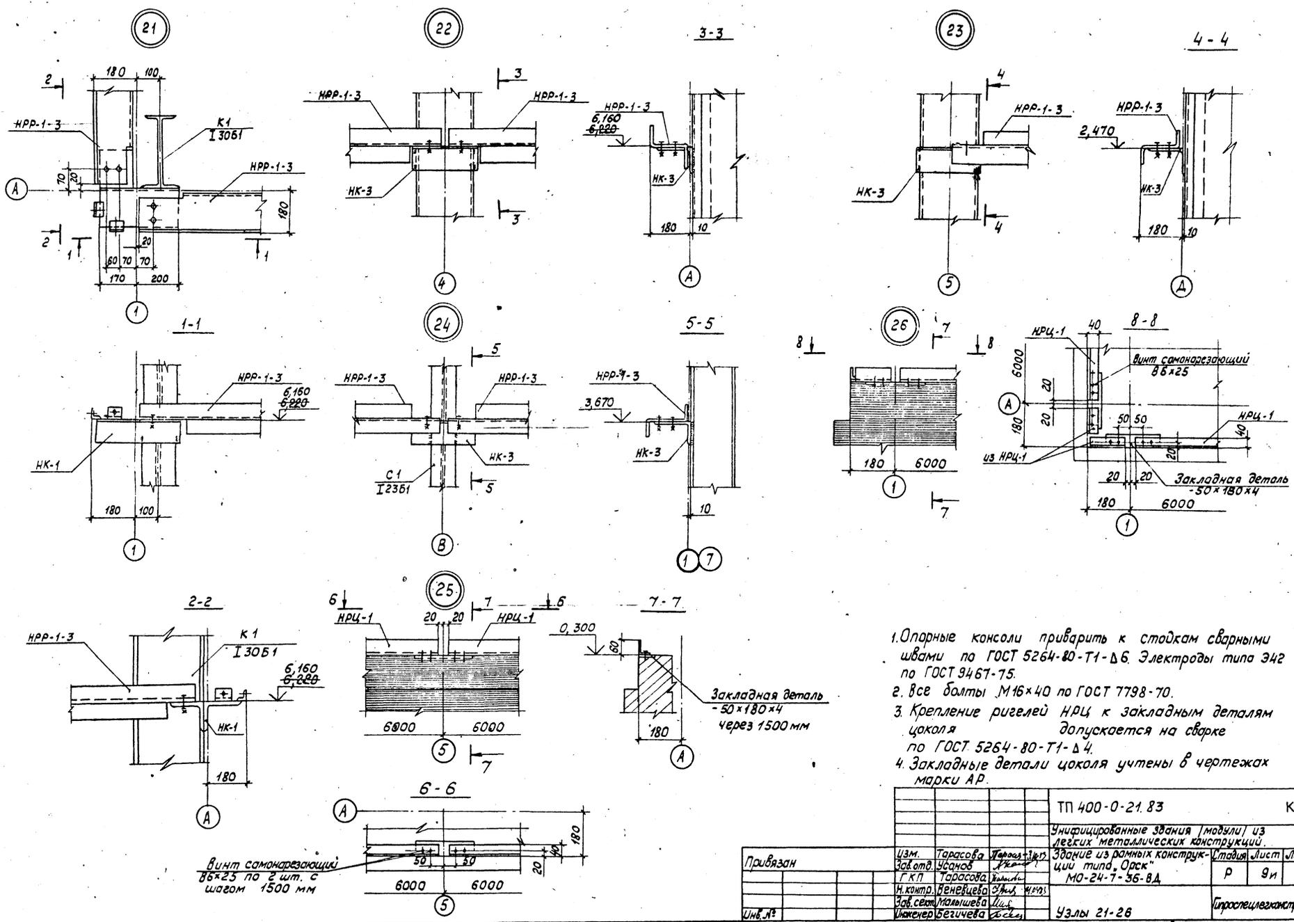
1. Опорные консоли приварить к стойкам сварными швами по ГОСТ 5264-80-T1-Δ6. Электроды типа Э42 по ГОСТ 9467-75.
