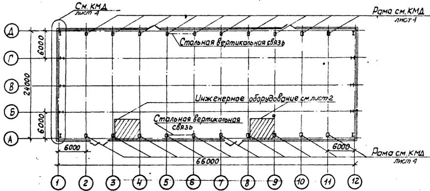
Схема плана кровли
