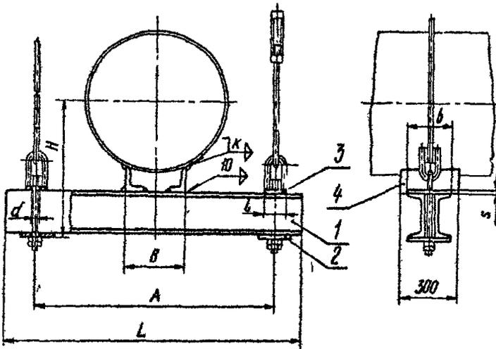
1 — балка опорная; 2 — плита опорная; 3 — планка; 4 — угольник
