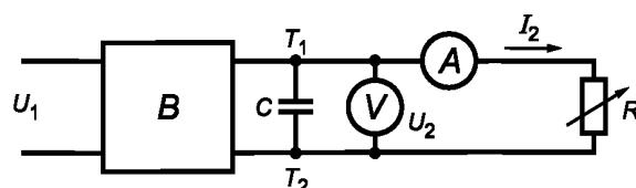
$U_1$  — напряжение питания;  $U_2$  — выходное напряжение;  $I_2$  — выходной ток;  $A$  — амперметр;  $B$  — зарядное устройство батарей;  $V$  — вольтметр;  $R$  — переменный резистор;  $T_1$  и  $T_2$  — выходные зажимы зарядного устройства батарей;  $C$  — конденсатор емкостью  $E$  в фарарадах, рассчитываемой по формуле
