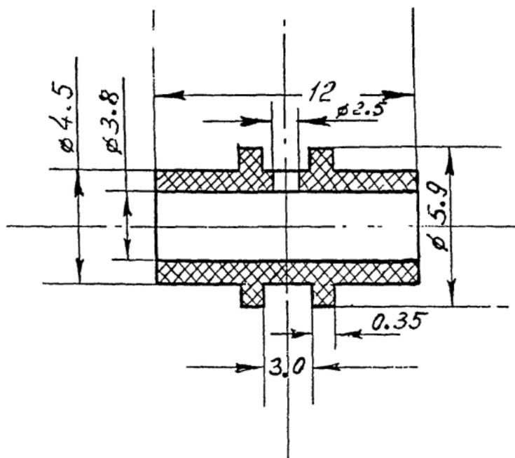
Рисунок 2 - Коаксиальная графитовая платформа
