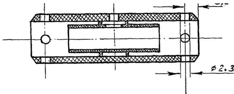
Рисунок 1 - Графитовые трубки с коаксиальной платформой
