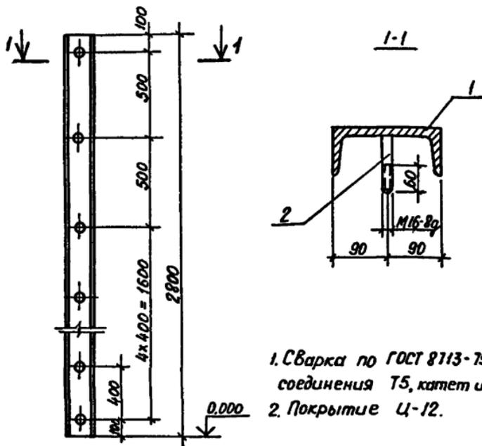
1. Сварка по ГОСТ 8713-79, тип соединения Т5, катет шва 5 мм.
