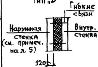
— облегченная кладка, состоящая из продольных наружной и внутренней стенок, соединенных гибкими связями. Утеплитель — плитный, заливочный (вспенивающийся), из блоков или засыпной.
