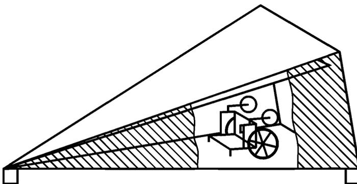
Рисунок 3 — Горизонтальная поляризация в ГТЕМ-камере
