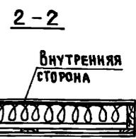
1. Прижимные планки поз. 4 ставятся равномерно по высоте с шагом 300 мм.
