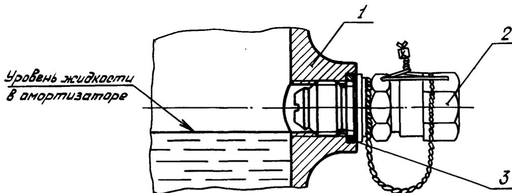
1 - корпус амортизатора; 2 - зарядный клапан; 3 - шайба или кольцо
