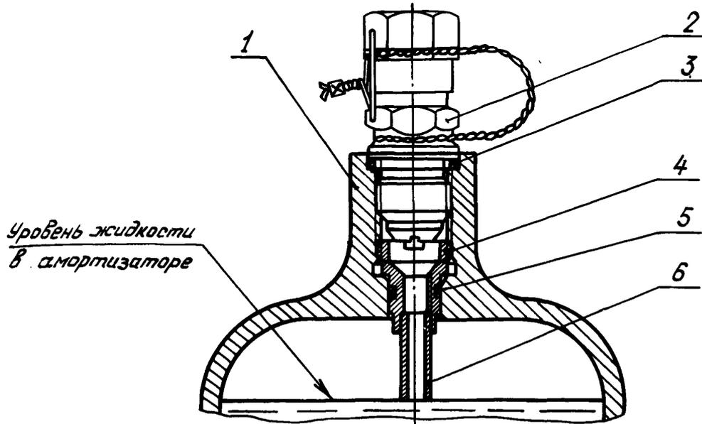
1 - корпус амортизатора; 2 - зарядный клапан; 3 - шайба или кольцо
