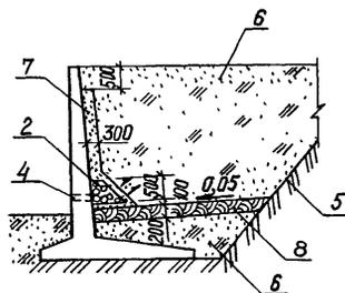
Рис. 15. Схема дренажа подпорных стен
