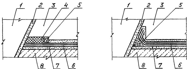
Рис. 19. Сопряжение оклеечной гидроизоляции дна
