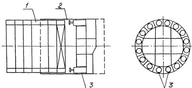
Рис. 23. Схема производства работ при щитовой проходке
