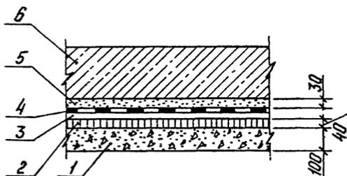
Рис. 8. Узел 4. Оклеечная гидроизоляция
