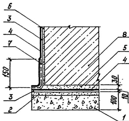
Рис. 24. Узел 20. Окрасочная гидроизоляция
