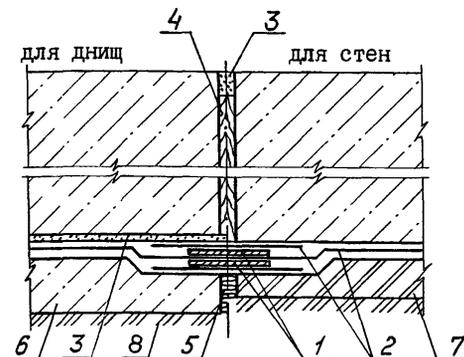
Рис.5. Деформационный и температурно-усадочный шов с прокладкой алюминиевых рулонных полос
