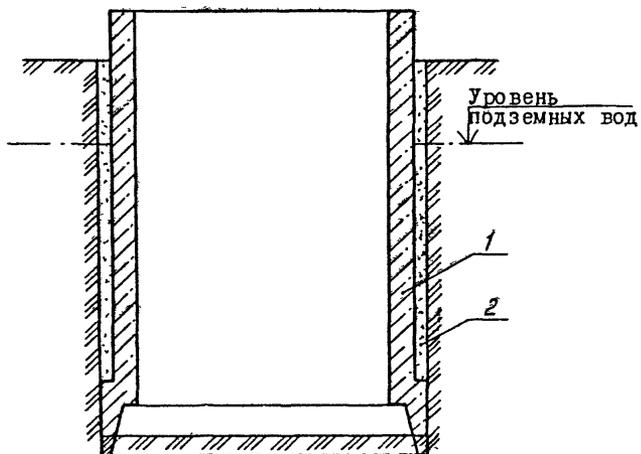
Рис. 18 Схема производства работ при строительстве сооружений способом опускного колодца
