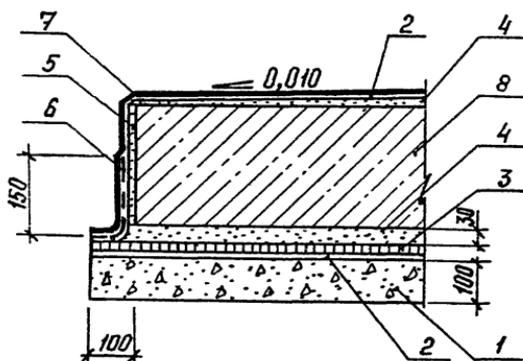
Рис. 18. Узел I4. Асфальтовая и окрасочная гидроизоляция
