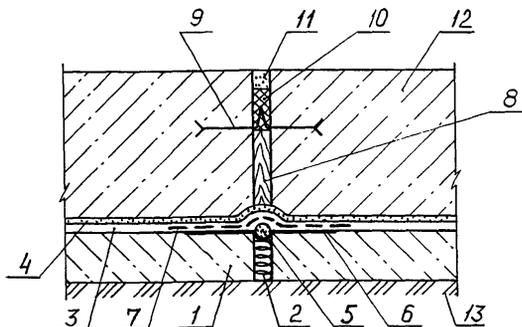
Рис. 4. Гидроизоляция деформационного шва при цементной штукатурной гидроизоляции
