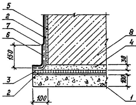
Рис. 25. Узел 21. Асфальтовая и окрасочная гидроизоляция
