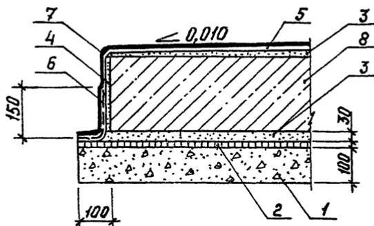
Рис. 19. Узел 15. Литая и окрасочная гидроизоляция
