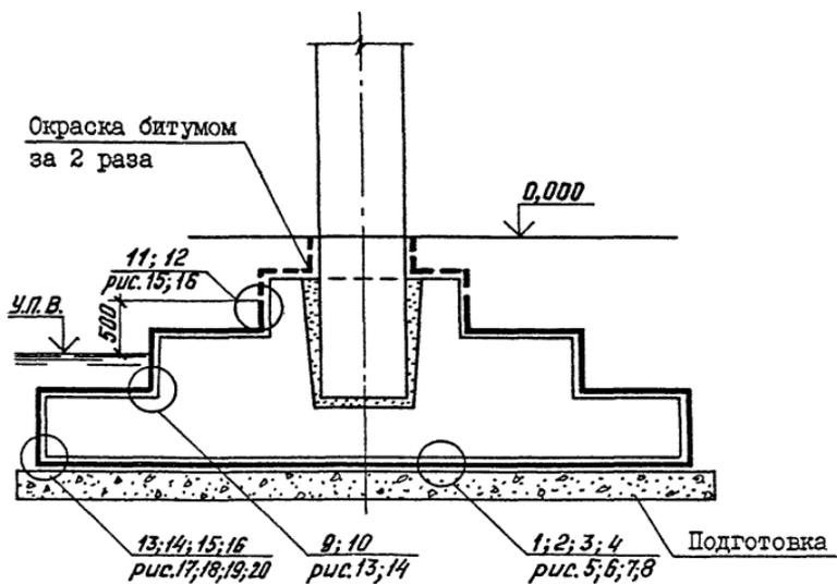
Рис. 2. Гидроизоляция фундамента под колонну
