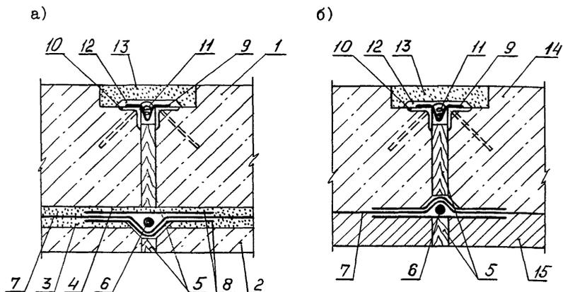
Рис. 7. Деформационные и температурно-усадочные швы со стальными съёмными компенсаторами
