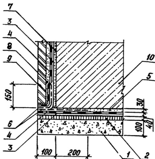
Рис. 27. Узел 23. Оклеечная гидроизоляция
