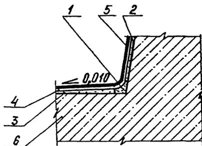
Рис. 21. Узел 17. Окрасочная гидроизоляция
