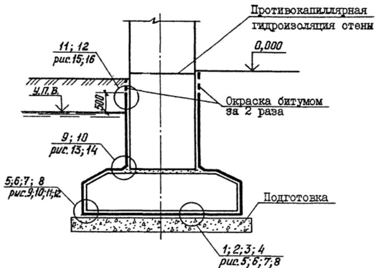
Рис. I. Гидроизоляция фундамента под стену
