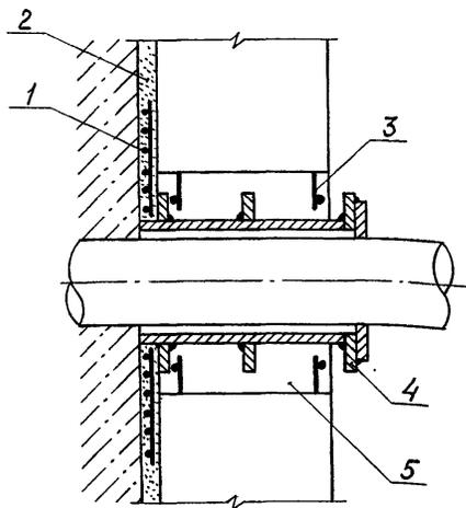
Рис. 20. Пример решения пропуска труб через стены
