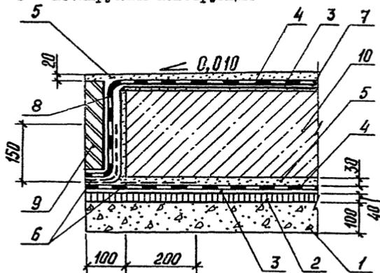
Рис. 20. Узел 16. Оклеечная гидроизоляция
