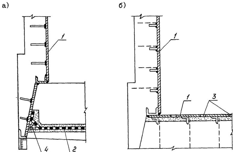
Рис. 21. Металлическая гидроизоляция опускных колодцев
