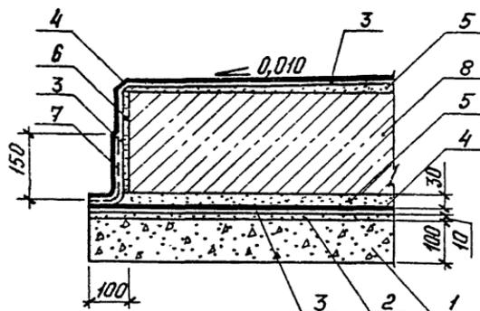
Рис. 17. Узел I3. Окрасочная гидроизоляция
