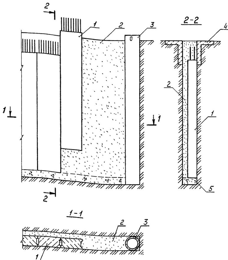
Рис.16. Схема производства работ при возведении стен способом "стена в грунте" из сборного железобетона
