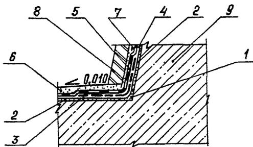
Рис. 22. Узел 18. Оклеечная гидроизоляция
