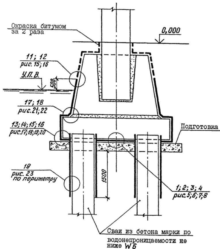
Рис. 3. Гидроизоляция свайного фундамента
