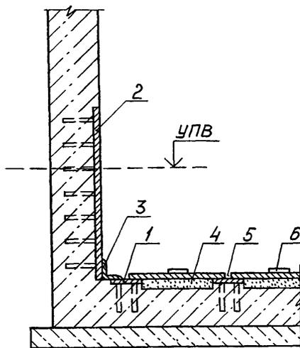
Рис. 13. Металлическая гидроизоляция тоннеля при наличии подземных вод
