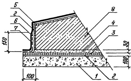
Рис. 10. Узел 6. Асфальтовая и окрасочная гидроизоляция
