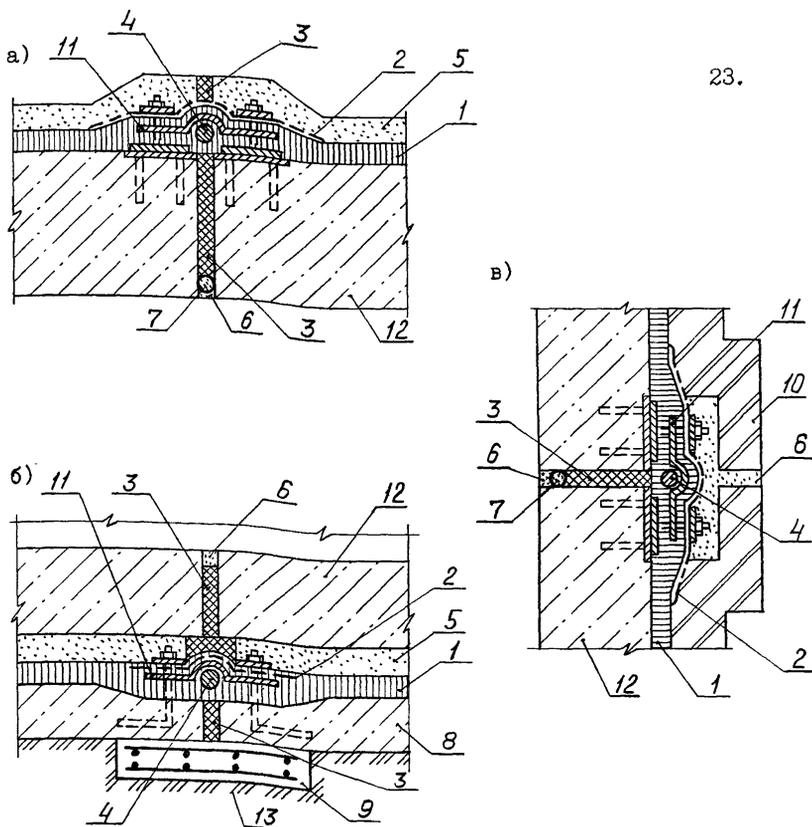
Рис. 3. Гидроизоляция деформационного шва в штукатурной гидроизоляции
