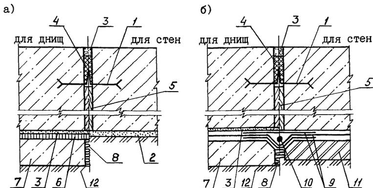
Рис.6. Деформационные и температурно-усадочные швы с медными (или резиновыми) компенсаторами
