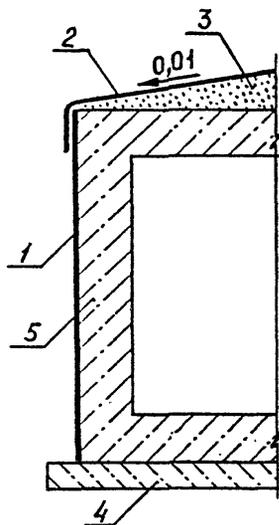
Рис.10 Гидроизоляция тоннеля при отсутствии подземных вод
