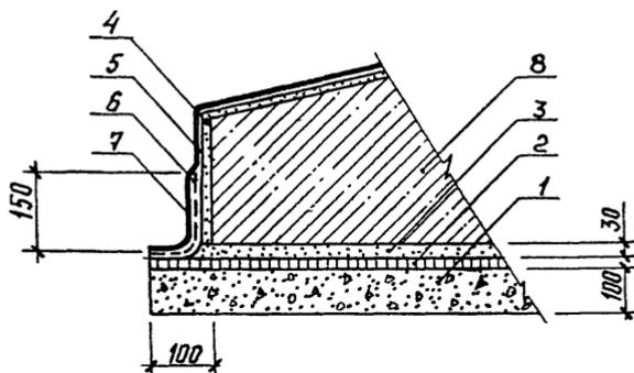
Рис. 11. Узел 7. Литая и окрасочная гидроизоляция
