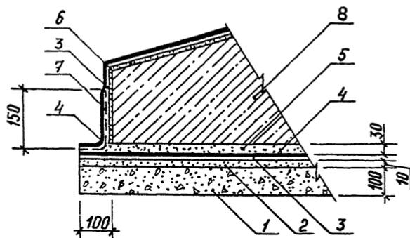
Рис. 9. Узел 5. Окрасочная гидроизоляция
