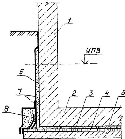
Рис. 12. Штукатурная цементная гидроизоляция тоннеля при наличии подземных вод
