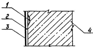
Рис. 23. Узел 19. Окрасочная гидроизоляция
