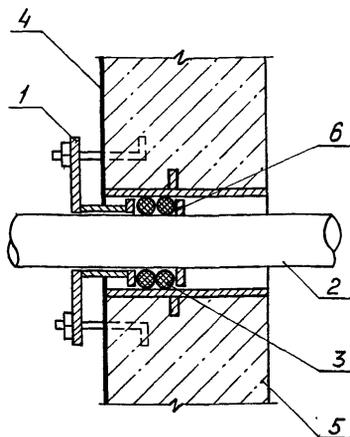
Рис. 9. Схема устройства пропуска технологических трубопроводов через гидроизоляцию с прижимным сальником
