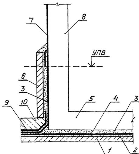
Рис. 11. Оклеечная гидроизоляция тоннеля при наличии подземных вод
