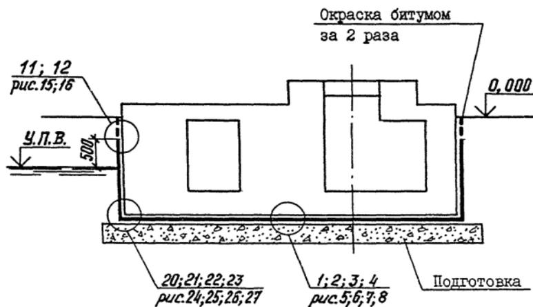
Рис. 4. Гидроизоляция фундамента под оборудование
