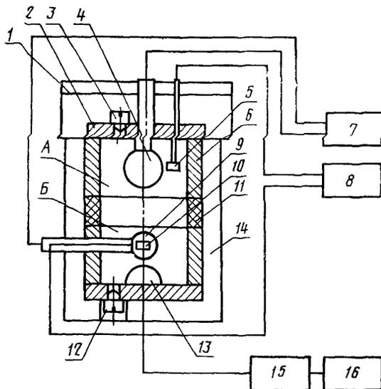
Установка для измерения чувствительности гидрофона:
