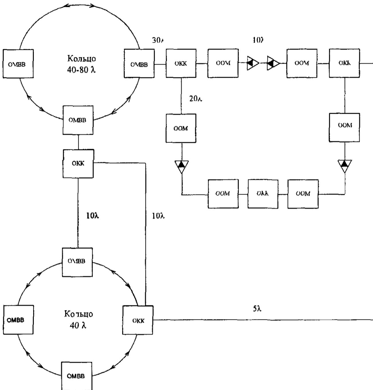
OMVB - оптический мультиплексор ввода/вывода
