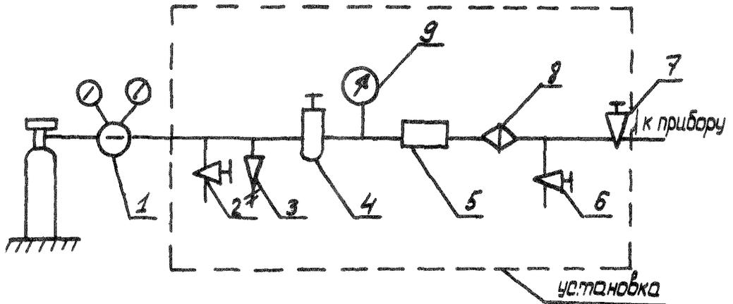
1 - редуктор; 2, 6, 7 - вентиль; 3 - предохранительный клапан; 4 - стабилизатор давления; 5 - осушитель; 8 - фильтр; 9 - манометр.
