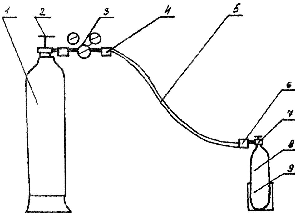
1 - баллон с водородом; 2, 7 - вентили баллонов; 3 - редуктор типа ДВП-165; 4, 6 - накидные гайки соединительного шланга; 5 - соединительный шланг, представляющий собой медную трубку М8х1,5 по ГОСТ 617-72, соединенную сваркой с переходниками и отожженную; 8 - заполняемый баллон; 9 - подставка.
