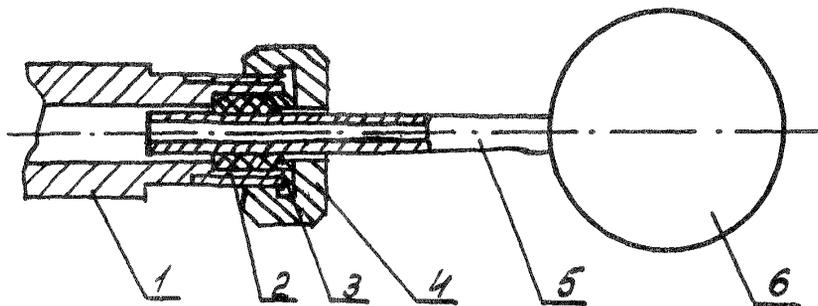
1 - установка; 2 - резиновое уплотнение; 3 - шайба; 4 - гайка; 5 - трубка; 6 - заполняемый прибор.
