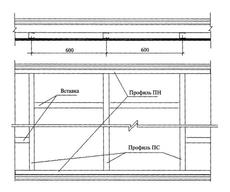
**Рисунок 25** — Схема монтажа каркаса в облицовке С 665
