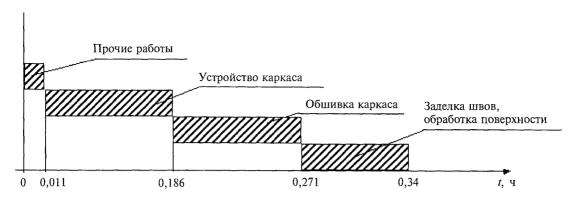
**Рисунок 4.1** — График движения рабочей силы
