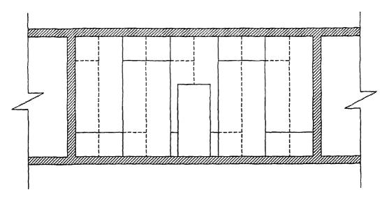
**Рисунок 8** — Схема расположения листов ГВЛ перегородки С 361 (сплошные линии — листы на лицевой стороне, пунктирные линии — листы на обратной стороне)
