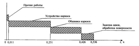
Рисунок 4.1 — График движения рабочей силы
