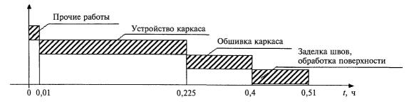
Рисунок 4.1 — График движения рабочей силы
