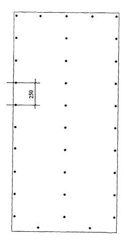
Рисунок 9 — Схема расположения самонарезающих винтов при однослойной облицовке
