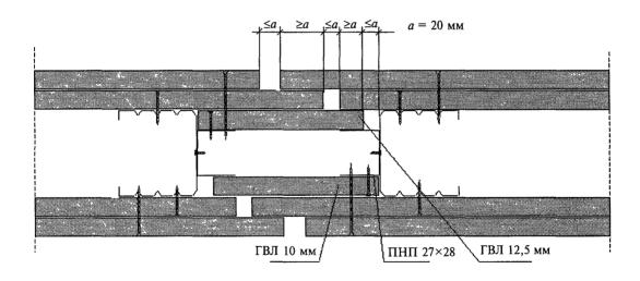
**Рисунок 11** — Схема устройства деформационного шва в перегородке С 362
