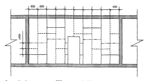
Рисунок 14— Схема расположения ГВЛ перегородки С 363 (сплошные линии — листы первого слоя, пунктирные — листы второго слоя, штрихпунктирные — листы третьего слоя; второй слой смещен относительно первого на один шаг стойки)
