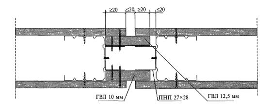
**Рисунок 10** — Схема устройства деформационного шва в перегородке С 361
