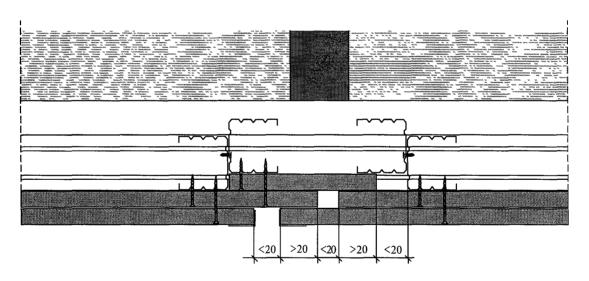
$\Pi$  р и м е ч а н и е —  $\Pi$ ри устройстве деформационных швов требуется установить дополнительно два стоечных профиля по обеим сторонам шва.
