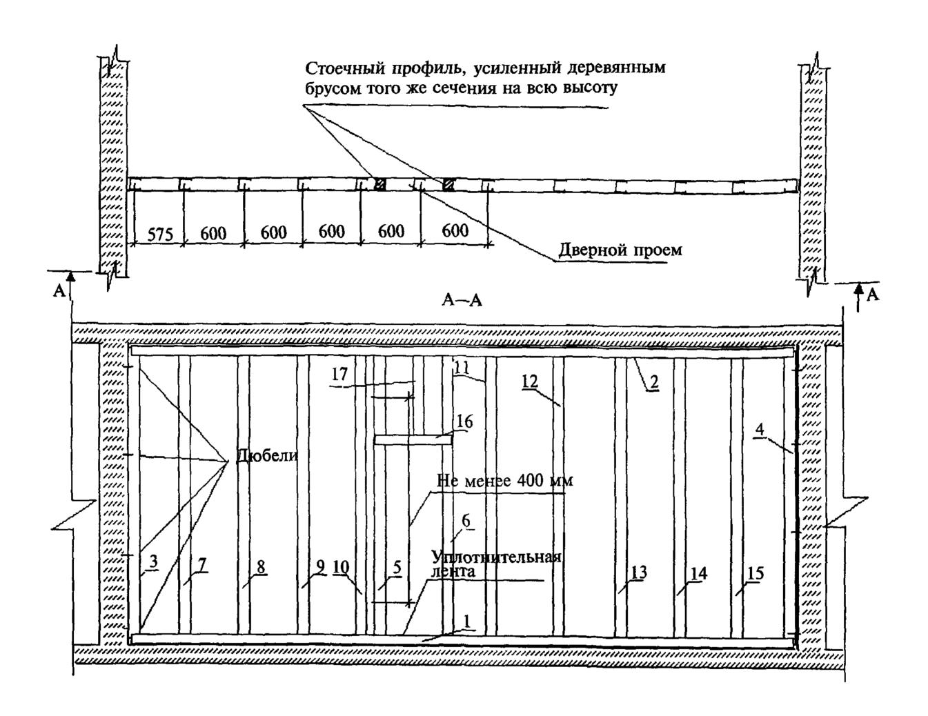
1, 2, 16— направляющий профиль (ПН); 3—15, 17— стоечный профиль (ПС) Рисунок 12— Схема монтажа элементов каркаса перегородки С 362
