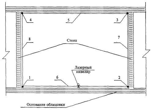
1, 2, 3, 4— нанесение точек на основные конструкции помещения; 5, 6, 7, 8— разметка оси шнуроотбойным устройством
