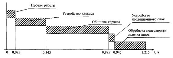
Рисунок 4.1 — График движения рабочей силы
