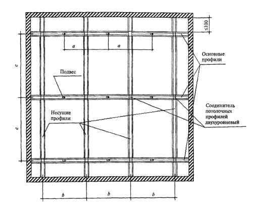
Межосевые расстояния при устройстве каркаса
