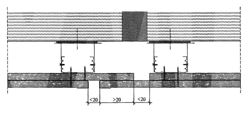
$\Pi$  р и м е ч а н и е —  $\Pi$ ри устройстве деформационных швов требуется установить дополнительно два потолочных профиля по обеим сторонам шва.
