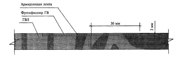
Рисунок 5 — Схема устройства горизонтального шва
