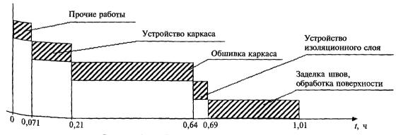
**Рисунок 4.1** — График движения рабочей силы
