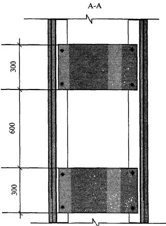
— направляющие профили пола; 2— стоечные профили, примыкающие к основным конструкциям; 3— стоечные профили; 4— вставка из ГВЛВ; 5— первый слой ГВЛВ; 6— второй слой ГВЛВ
