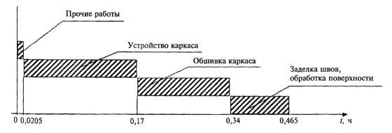
Рисунок 4.1 — График движения рабочей силы
