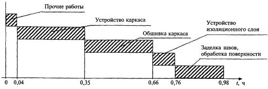
**Рисунок 4.1** — График движения рабочей силы
