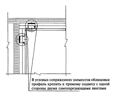
Рисунок 23 — Схема крепления стоек каркаса с помощью прямых подвесов в облицовке С 663
