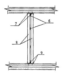
— направляющие пола и потолка; 2 — стойки несущего каркаса; 3 — первый слой ГВЛ с двух сторон; 4 — второй слой ГВЛ с двух сторон; 5 — разделительная лента; 6 — уплотнительная лента; 7 — профиль направляющий потолка; 8 — профиль стоечный: 9 — профиль направляющий пола
