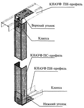
Рисунок 7 — Монтаж элементов дверного проема
