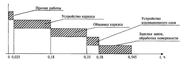
Рисунок 4.1 — График движения рабочей силы
