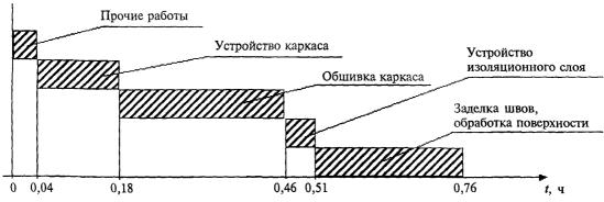
Рисунок 4.1 — График движения рабочей силы
