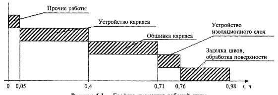
Рисунок 4.1 — График движения рабочей силы
