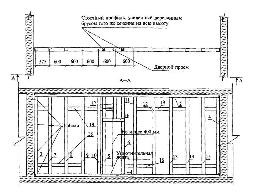
$1-\Pi H$  на полу;  $2-\Pi H$  на потолке; 3,  $4-\Pi C$ , примыкающие к конструкциям здания; 5,  $6-\Pi C$ , ограничивающие дверной проем; 7-15- монтаж профиля каркаса с сохранением проектного шага; 16- монтаж перемычки над дверным проемом; 17- монтаж  $\Pi C$  с сохранением шага над дверным проемом; 18, 19- монтаж горизонтальных вставок из  $\Pi H$  под горизонтальные швы  $\Gamma K \Pi$
