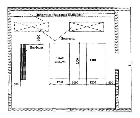
Рисунок 21 — Схема организации рабочего места при облицовке стен
