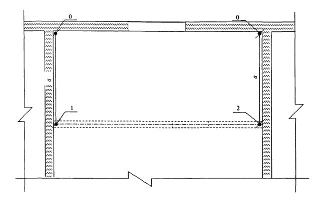
1, 2— ось каркаса перегородки, параллельная основной конструкции здания; a— расстояние между стеной и осью перегородки (план)
