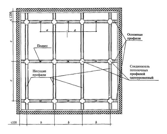
Межосевые расстояния при устройстве каркаса
