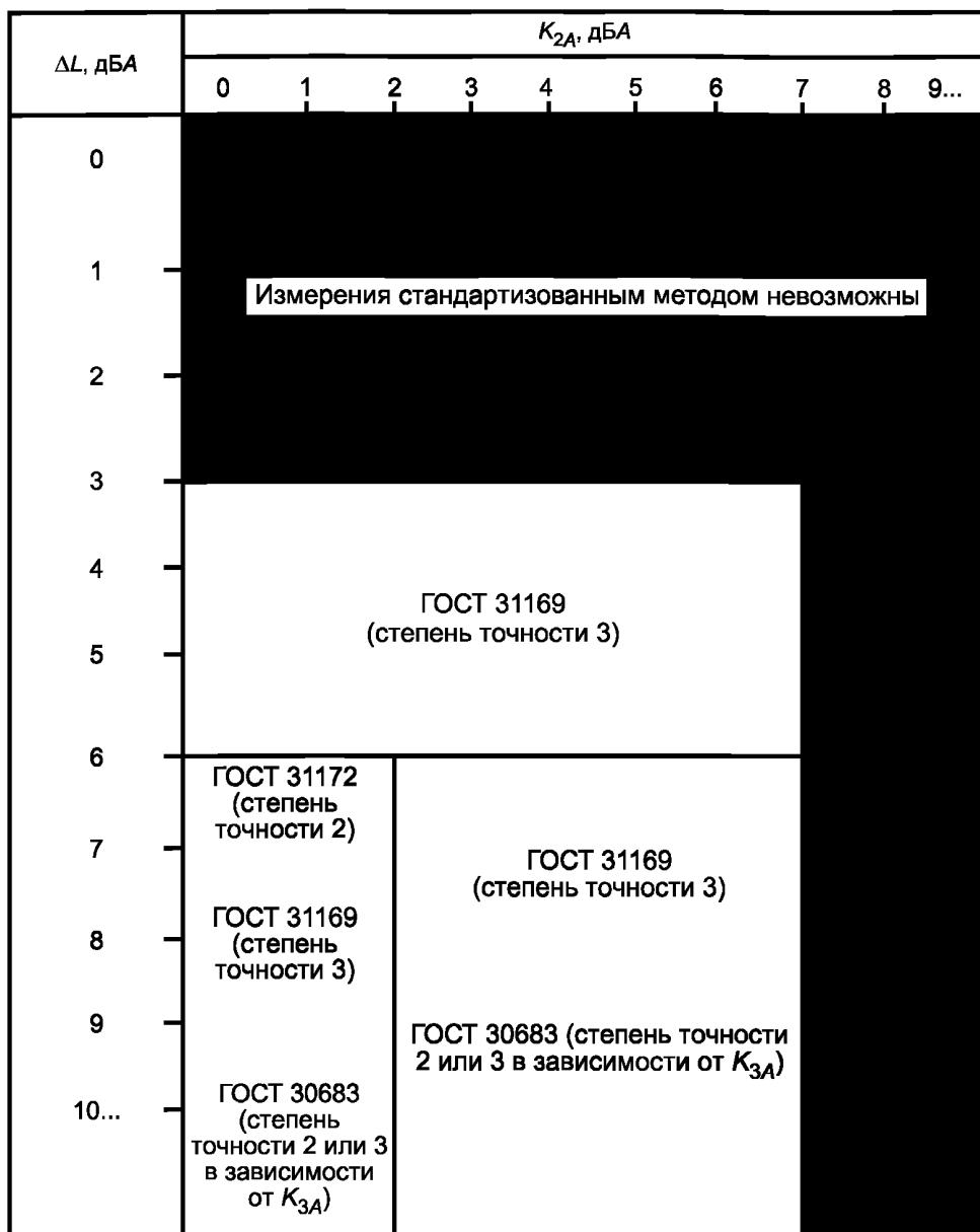
Рисунок 2 — Область действия методов по ГОСТ 31172, ГОСТ 31169 и ГОСТ 30683 в зависимости от разности между измеренным уровнем звукового давления и уровнем фонового шума ( $\Delta L$ ), от показателя акустических условий  $K_{2A}$  и локальной коррекции на акустические условия  $K_{3A}$
