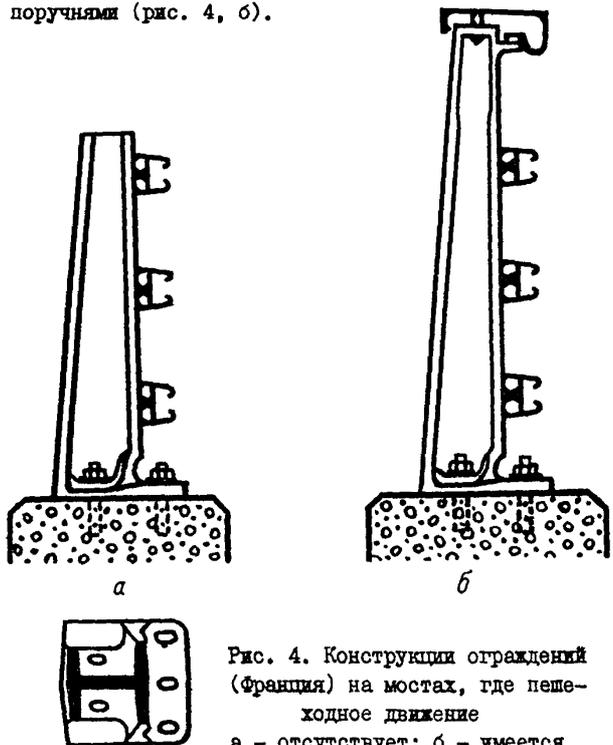
Рис. 4. Конструкции ограждений (Франция) на мостах, где пешеходное движение
