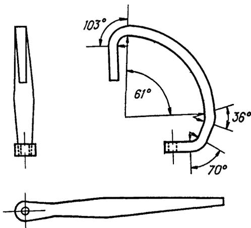
Рис. 5. Специальный амортизатор, предотвращающий опрокидывание и "прорыв" автомобиля
