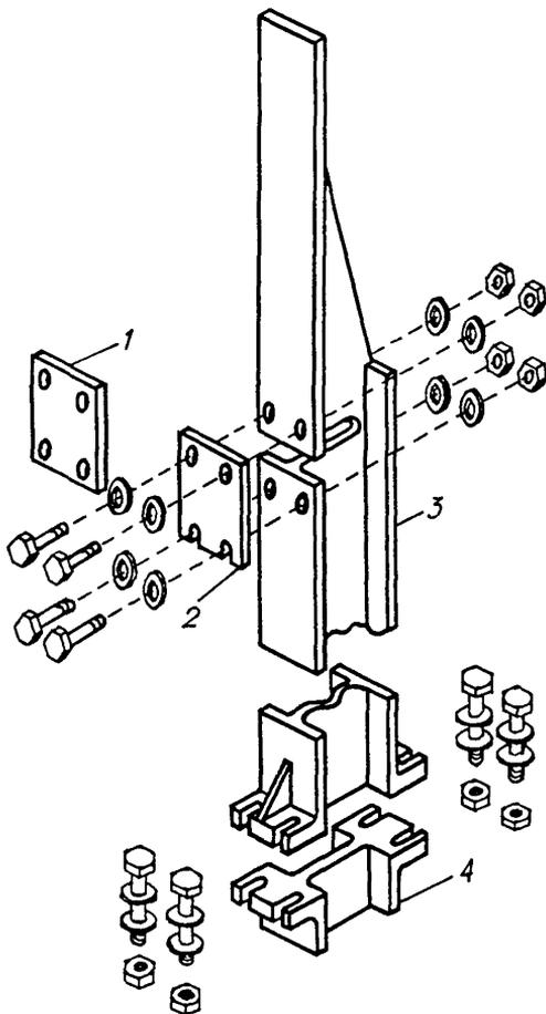
Рис. 8. Детали конструкции опор разрушающихся знаков:
