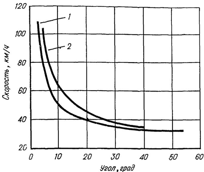
Рис. 22. Зависимость угла наезда на препятствие или съезда с дороги от скорости в момент ДТП:
