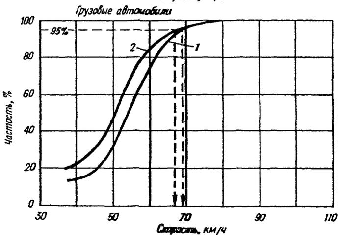
Рис.20. Распределение скоростей транспортных средств, участвовавших в наездах на препятствия и съездах с дороги: 1 - дороги I-III технических категорий; 2 - дороги IV-V технических категорий
