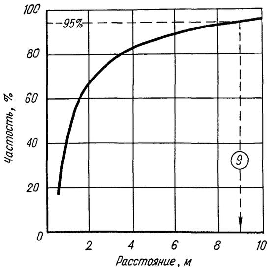
Рис. 13. Распределение количества автомобилей, съезжающих с откосов насыпей
