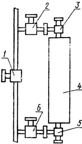
1, 2, 3, 5, 6—вентили запорного типа; 4—стальной пробоотборник проточного типа.
