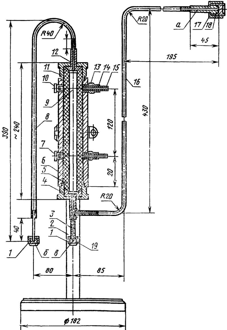
а—ввод продукта в ячейку; б—выход газа; в—трубка для опорожнения ячейки; 1, 10, 11, 13, 17—гайки; 2—штатив; 3, 12, 18—ниппели; 4—штуцер; 5—вкладыш; 6—корпус; 7, 14—втулки; 8, 16—трубы; 9—электрод; 15—контакт; 19—гайка для крепления вентиля  $D_y=2$  мм.
