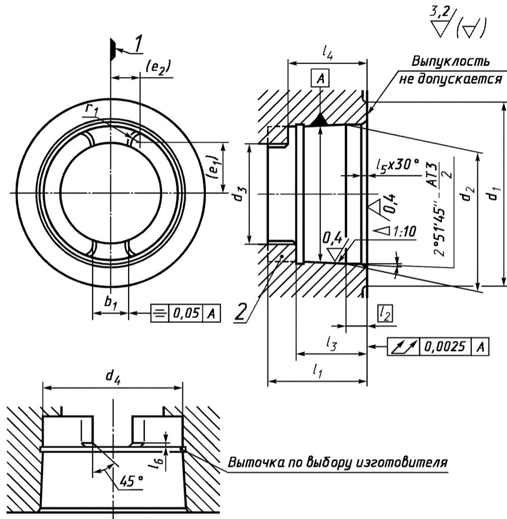
1 — плоскость расположения вершины режущей кромки однолезвийного инструмента; 2 — поводок по выбору изготовителя выполняется вместе с посадочным гнездом или отдельно
