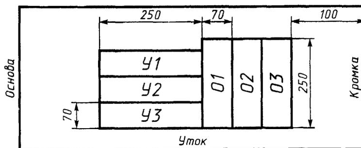
У<sub>1</sub>, У<sub>2</sub>, У<sub>3</sub> — заготовки уточных пробных полосок;
