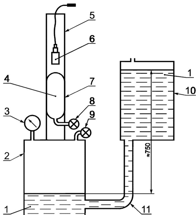
1 — вода; 2 — нижняя емкость диаметром 380 мм, высотой 350 мм; 3 — манометр с диапазоном измерений от 0 до 40 кПа; 4 — воздушный шарик; 5 — прозрачная пластиковая трубка диаметром 75 мм, длиной 450 мм; 6 — датчик; 7 — отверстие для иглы; 8 — газ; 9 — входной штуцер; 10 — верхняя емкость вместимостью 20 дм<sup>3</sup>; 11 — шланг
