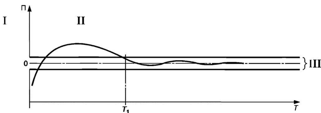
I — питание выключено; II — питание включено; III — пределы допустимых отклонений показания прибора в чистом воздухе; П — показание; T — время; 0 — ноль прибора;  $T_1$  — время прогрева (см. 2.6.7)
