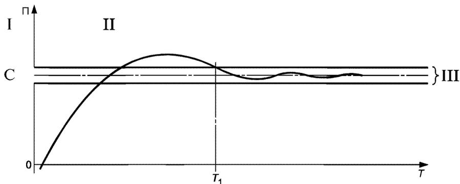
I — питание выключено; II — питание включено; III — пределы допускаемых отклонений показания прибора в ПГС;  $P$  — показание;  $T$  — время; 0 — ноль прибора;  $T_1$  — время прогрева (см. 2.6.7);  $C$  — объемная доля горючего газа в ПГС
