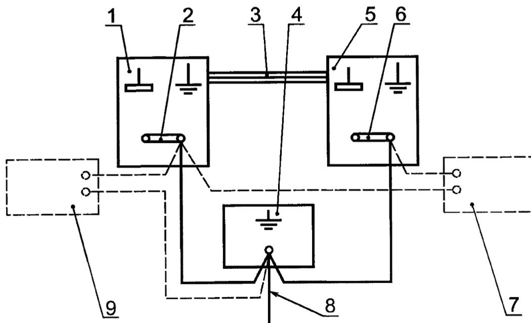
Если монтаж системы заземления выполнен таким образом, что имеется опорный узел заземления всех стоек, то испытательные посылки тока подают также между этим узлом и зажимами защитного заземления стоек, отстоящих от узла не далее 3 м (см рисунок 4)
