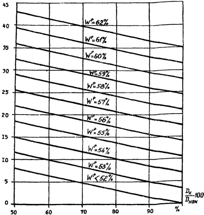
Рис.3. Зависимость расходов мазута на подовечивание торфяного факела  $X^m$  (в % по тепловыделению) от влажности торфа -  $W^p$  и нагрузки котла -  $\frac{D_K}{D_{ном}} \cdot 100\%$
