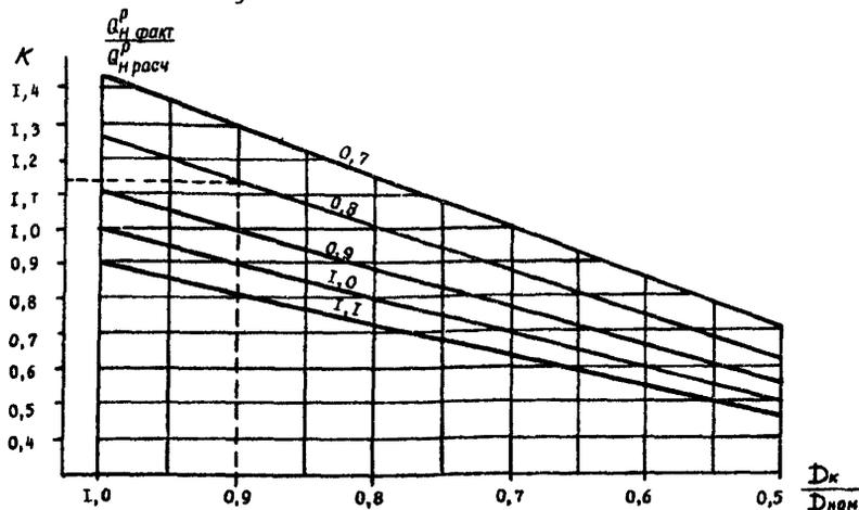
Рис. 4. Пример пользования графиком при отношении фактической нагрузки котла к номинальной  $\frac{D_K}{D_{ном}} = 0,9$  и отношении фактической теплоты сгорания торфа к расчетной  $\frac{Q_{н\text{факт}}^P}{Q_{н\text{расч}}^P} = 0,8$ .
